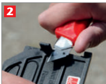
2 Klip A links und rechts mit dem Cutter entfernen
