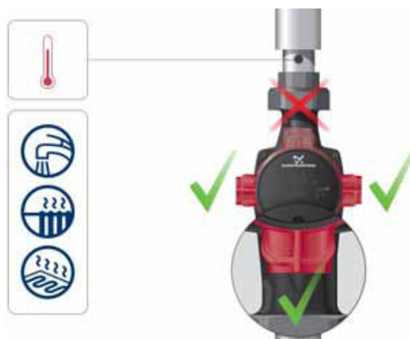
Abb. 3 Position des Schaltkastens in Heizungs- und Trinkwarmwasseranlagen
