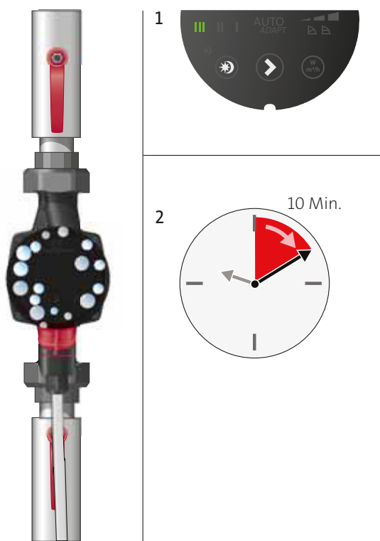
Abb. 13 Entlüften der Pumpe
