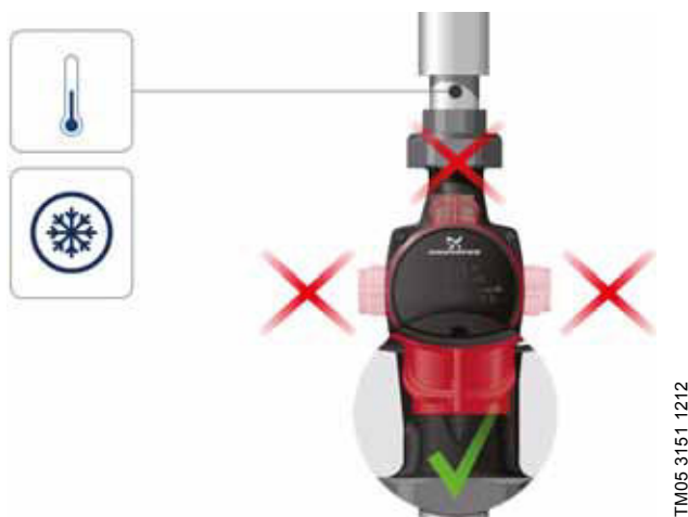
Abb. 4 Position des Schaltkastens in Klima- und Kaltwasseranlagen
