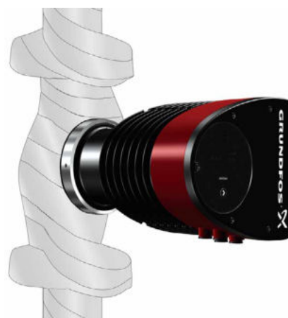
Abb. 14 Dämmen des Pumpengehäuses und der Rohrleitungen
