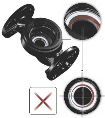
Abb. 12 Falsch zentriertes Dichtungssystem
