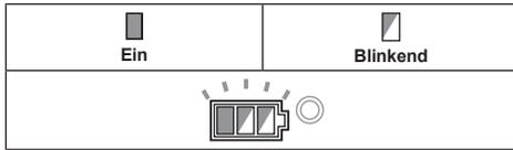
Falls das Werkzeug nicht startet, ist der Akku möglicherweise überhitzt. Lassen Sie den Akku in dieser Situation abkühlen, bevor Sie das Werkzeug wieder starten.
