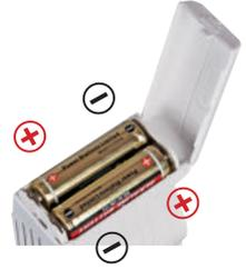
**ACHTUNG!** Sollte der Batteriewechsel länger als 20 s dauern, werden auf der Anzeige alle Angaben gelöscht. **Die Anzeige wird erst nach dem Batteriewechsel aktiviert!**
