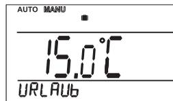
Stellen Sie die Temperatur ein, die der Thermostat während der Urlaubszeit halten soll, und geben Sie das Datum für die Anreise aus dem Urlaub ein. Durch das Drehen der Taste "↘" führen Sie die Änderung von Werten durch, die Sie durch das Drücken der Taste "↻" immer bestätigen. Nach der Einstellung drücken Sie bitte die Taste "ESC" um ins Grundmenü zu kommen.
