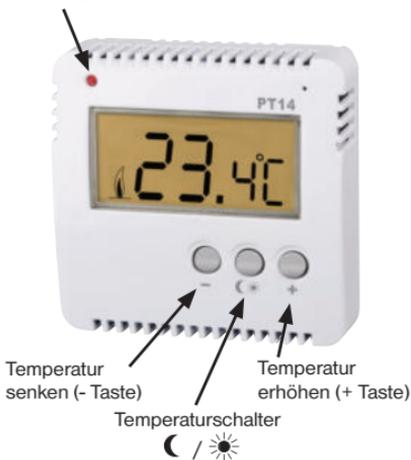
Nach der ersten Betätigung der **+** oder **-** Taste wird zuerst die LCD-Hintergrundbeleuchtung aktiviert. Wenn Sie die Tasten wieder drücken, stellen Sie hiermit die Soll-Temperatur ein. Der Raumthermostat ermöglicht die Einstellung der Temperatur im Bereich von 3 °C bis 39 °C.
