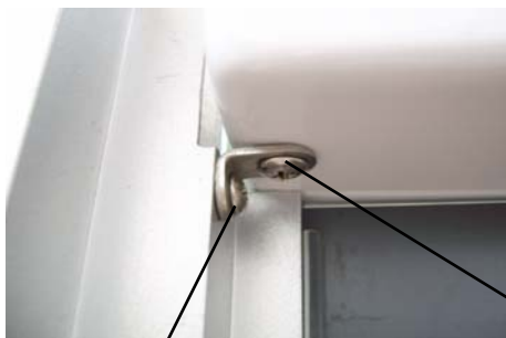
Použít šrouby 4,2x12 Svislé profily spojit se střešou use screws 4,2x12, link the vertical profiles with top panel
