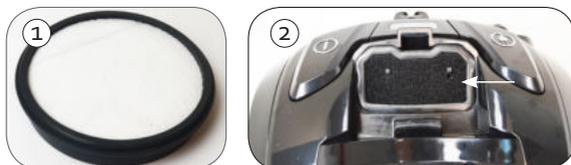
3. Achteraan het toestel zit een rooster voor de hepa-filter. Deze kan je eenvoudig verwijderen door het klepje van het rooster naar rechts te schuiven, en het rooster uit het toestel te nemen. De hepa-filter neem je uit het toestel door het klepje naar links te trekken.
