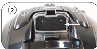
3. Schließlich finden Sie an der Rückseite des Geräts ein Gitter für den Hepa-Filter. Diesen können sie einfach entfernen, indem Sie die Klappe des Gitters nach rechts schieben und das Gitter aus dem Gerät nehmen. Den Hepa-Filter nehmen Sie aus dem Gerät, indem Sie die Klappe nach links ziehen.
