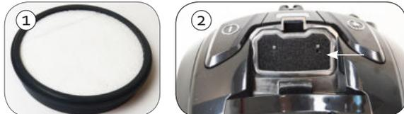
3. Na zadní straně vysavače je mřížka pro HEPA filtr. Mřížku lze snadno zatlačením spony odstranit (směrem doprava). HEPA filtr ze spotřebiče vyjmete stisknutím a zatlačením doleva.
