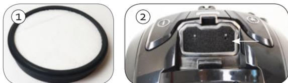
3. Dietro all'apparecchio c'è una griglia per il filtro HEPA. È possibile toglierlo con facilità spostando verso destra la levetta della griglia e togliendo quest'ultima dall'apparecchio. Togliere il filtro HEPA nell'apparecchio tirandolo verso sinistra.
