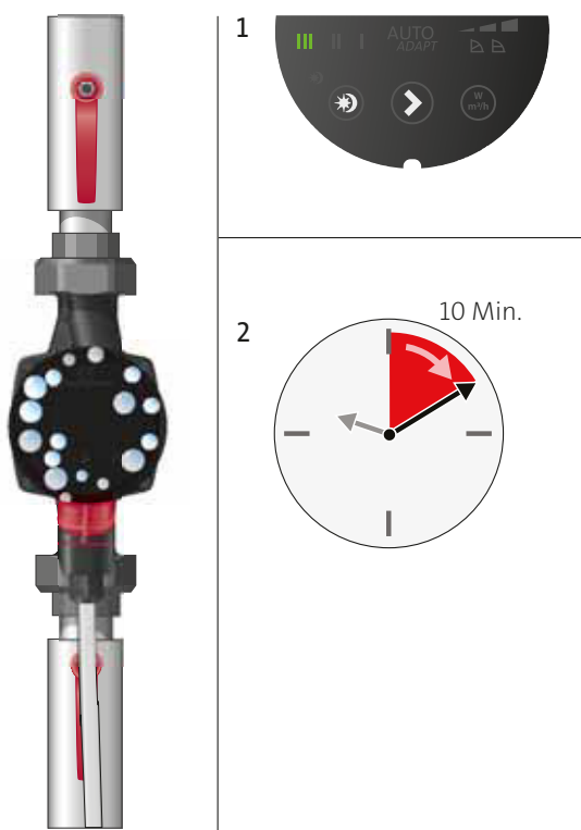
Obr. 13 Odvzdušnění čerpadla
