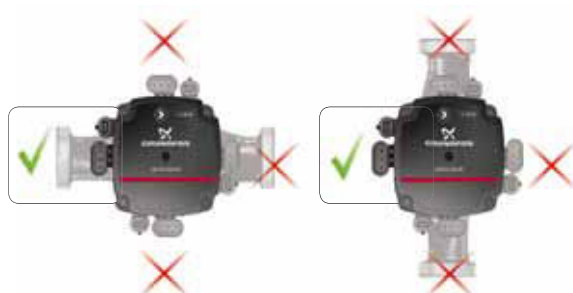
Obr. 6 Polohy řídicí jednotky, ALPHA SOLAR
