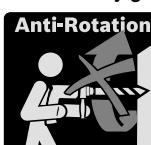
Lai ierobežotu reaktivo griezes momentu, elektroinstruments ir aprīkots ar pārslodzes sajūgu (Anti-Rotation = kas pārtrauc darbavārpstas rotāciju).
