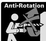
С целью ограничения высоких реакционных моментов электроинструмент оснащен предохранительной муфтой (Anti-Rotation).
