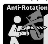
Na obmedzenie nebezpečných reakčných momentov je toto ručné elektrické náradie vybavené ochrannou spojkou proti preťaženiu (Anti-Rotation).
