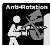
Kako bi ste ograničili visoki momenti reakcije, električni alat je opremljen sklopkom protiv preopterećenja (Anti-Rotation).
