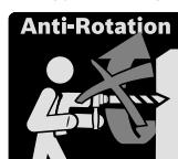
Aby ograniczyć wysokie momenty odwodzące, elektronarzędzie zostało wyposażone w sprzęgło przeciążeniowe (Anti-Rotation).
