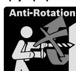
Pro omezení vysokých reakčních momentů je elektronářadí vybaveno spojkou proti přetížení (Anti-Rotation).
