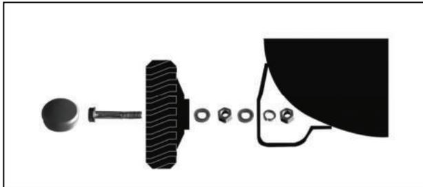
1. Montieren Sie die Räder wie in der Abbildung zu sehen am Kompressor.
