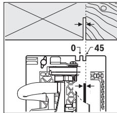
La marca de posición para 0° (9) muestra la posición de la hoja de sierra en caso de corte en ángulo recto. La marca de corte 45° (8) muestra la posición del disco de sierra en caso de corte de 45°.
