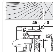
Le marquage de coupe 0° (9) indique la position de la lame de scie lors d'une coupe à angle droit. Le marquage de coupe 45° (8) indique la position de la lame de scie lors d'une coupe à 45°.
