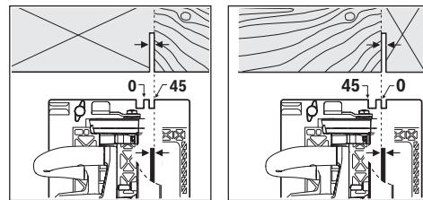
เครื่องหมายตัด 0° (9) แสดงตำแหน่งของใบเลื่อยสำหรับการตัด เครื่องหมายตัด 45° (8) แสดงตำแหน่งของใบเลื่อยสำหรับการตัด 45°
