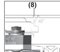
Chỉ sử dụng đánh dấu vết cắt (8) đối với vết cắt vuông góc và vết cắt  $45^\circ$  có ray dẫn hướng.
