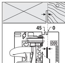
La marca de posición para 0° (8) muestra la posición de la hoja de sierra en caso de corte en ángulo recto. La marca de corte 45° (9) muestra la posición del disco de sierra en caso de corte de 45°.
