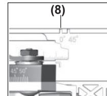
Utilice solamente la marca de corte (8) en el caso de un corte rectangular y un corte de 45° con riel de guía.
