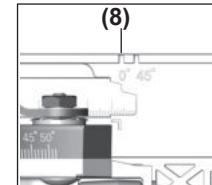
Cukup gunakan tanda pemotongan (8) saat memotong bentuk persegipanjang dan siku-siku  $45^\circ$  dengan rel pemandu.
