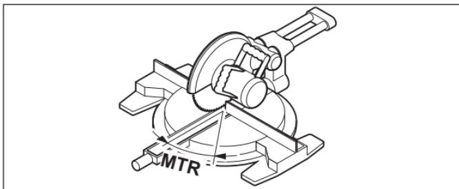
Ponovo pritisnite taster **COM (7)**. Na displeju se prikazuje **MTR** i izračunati horizontalni ugao iskošenja za testeru za rezanje i iskošenje. Pomoću horizontalnog ugla iskošenja utvrđuje se obrtanje stola za testerisanje (**MTR**).
