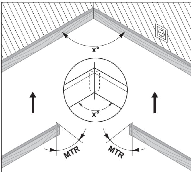
Рассчитывается горизонтальный угол распила **MTR** («Miter Angle»: горизонтальный угол распила), на который необходимо срезать 2 заготовки. Пильный диск находится при такой косой распиловке перпендикулярно к заготовке (вертикальный угол распила составляет  $0^\circ$ ).
