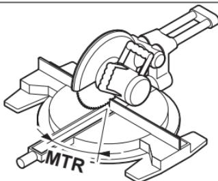
Pritisnite taster **MTR (8)**. Sve dok taster **MTR (8)** držite pritisnut, prikazuje se utvrđeni horizontalni ugao iskošenja **MTR**, koji mora da se podeši na testeri za rezanje i iskošenje. Istovremeno svetli indikator **MTR** na displeju.
