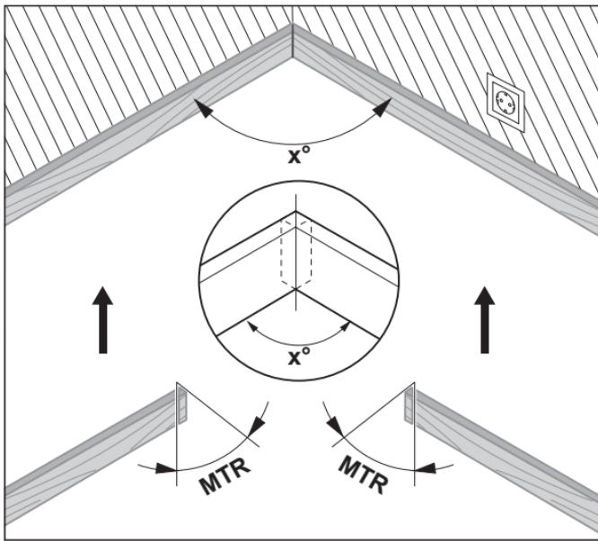
Ќе се пресмета хоризонталниот агол на закосување **MTR** („Miter Angle“: хоризонтален агол на закосување), за кратење на двета дела што се обработуваат. Сечилото за пилата кај ваквото сечење со закосување стои вертикално на делот што се обработува (вертикалниот агол на закосување изнесува  $0^\circ$ ).
