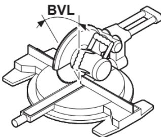
Apasă din nou tasta **COM (7)**. Pe afișaj sunt prezentate **BVL** și unghiul de îmbinare pe colț în plan vertical calculat pentru ferăstrăul de retezat și pentru îmbinări pe colț.
