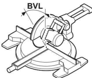
Знову натисніть на кнопку **COM (7)**. На дисплей відображається **BVL** і розраховане значення вертикального кута розпилювання для торцюально-вусорізної пилки.
