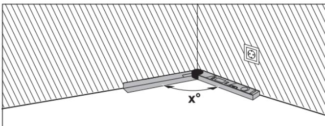
Если заготовки должны состыковываться в угле (напр., в случае плинтусов), измерьте угловой угол **x°**, приложив откидное и основное плечо. Для заданных углов (напр., в случае с картинными рамами) разведите
