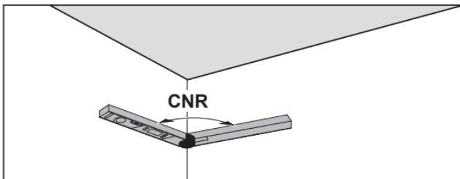
Sklopivi i osnovni krak za merenje ugla čoška položite ravno na zid ili podesite poznati ugao čoška na mernom alatu.
