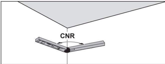
Zložljivi in osnovni krak za merjenje vogalnega kota položite plosko na stene ali na merilni napravi nastavite znan vogalni kot.
