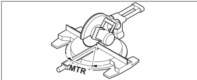
Ponovno pritisnite tipku **COM (7)**. Na zaslonu se pojavljuju **MTR** i izračunati horizontalni kut kosog rezanja za preklopnu pilu. Pomoću horizontalnog kuta kosog rezanja određuje se okretanje stola za piljenje (**MTR**).
