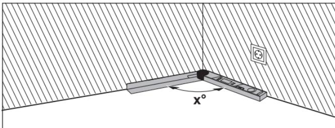
Ако обработватите детайли са в ъгъл (напр. за подови лайстни), то измерете ъгъла  $x^\circ$  чрез поставяне на разгъващото се и основното рамо. За предвидения ъгъл (напр. картична рамка) отворете разгъващото се и основното рамо дотолкова, че желанияят ъгъл да се покаже на дисплея.
