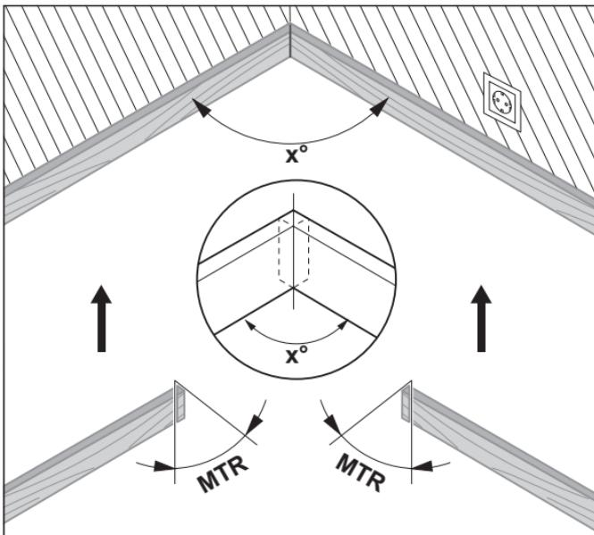
Vypočíta sa horizontálny uhol zošikmenia **MTR** („Miter Angle“: horizontálny uhol zošikmenia), o ktorý je nutné obidva obrobky skrátiť. Pílový list sa pri týchto šikmých rezoch nachádza zvisle k obrobku (vertikálny uhol zošikmenia je  $0^\circ$ ).
