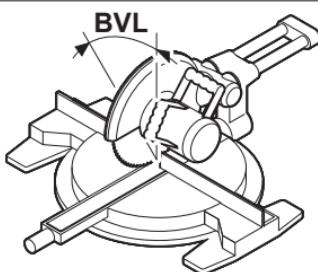
Ponovo pritisnite tipku **COM (7)**. Na zaslonu se pojavljuju **BVL** i izračunati vertikalni kut kosog rezanja za preklopnu pilu.
