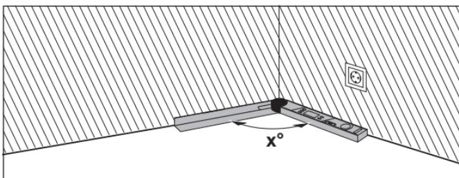
Dacă piesele de prelucrat trebuie să fie montate într-un colț (de exemplu, pentru plinte), măsoară unghiul de colț  $x^\circ$  reglând brațul mobil și brațul fix. Pentru unghiiurile prestabilite (de exemplu, rame de tablouri) deschide brațul mobil și brațul fix astfel încât pe afișaj să fie prezentat unghiul dorit.
