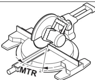
Stiskněte tlačítko **MTR** (8). Dokud budete držet tlačítko **MTR** (8) stisknuté, bude zobrazený vypočítaný vodorovný pokosový úhel **MTR**, který je nutné nastavit na kapovací a pokosové pile. Zároveň svítí ukazatel **MTR** na displeji.
