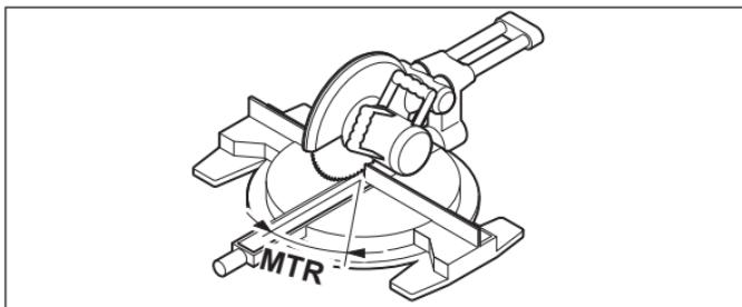
Снова нажмите на кнопку **COM (7)**. На дисплее отображается **MTR** и рассчитанный горизонтальный угол распила для торцовоно-усорезной пилы. По горизонтальному углу скоса задается поворот стола (**MTR**).
