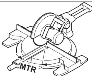
Znovu stiskněte tlačítko **COM (7)**. Na displeji se zobrazí **MTR** a vypočítaný vodorovný pokosový úhel pro kapovací a pokosovou pilu. Pomocí vodorovného pokosového úhlu se stanoví otočení stolu pily (**MTR**).
