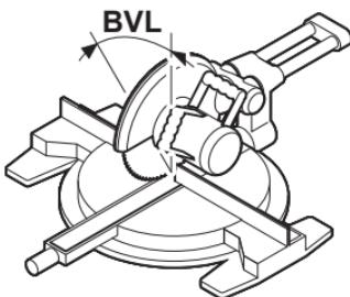
Снова нажмите на кнопку **COM (7)**. На дисплее отображается **BVL** и рассчитанный вертикальный угол распила для торцовочно-усорезной пилы. По вертикальному углу скоса задается наклон пильного полотна (**BVL**).
