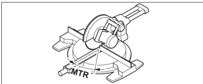
Натиснете отново бутона **COM (7)**. На дисплея се показват **MTR** и изчисленият хоризонтален ъгъл на скосяване за челния и скояващ циркуляр. Хоризонталният ъгъл на скосяване задава завъртането на основната плоча на циркулярената машина (**MTR**).
