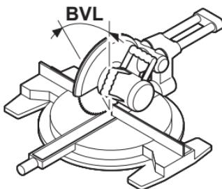
Ponovo pritisnite taster **COM (7)**. Na displeju se prikazuje **BVL** i izračunati vertikalni ugao iskošenja za testere za rezanje i iskošenje.
