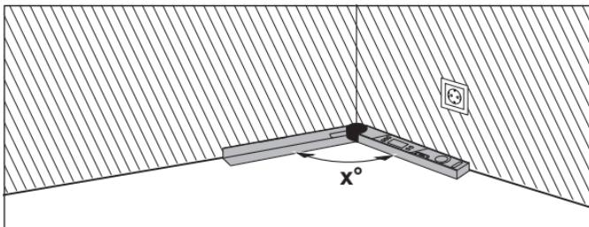
Ako se izradci trebaju pripasati u ugлу (npr. za podne letvice), u tom slučaju izmjerite kut u ugлу  $x^\circ$  polaganjem preklopnog i osnovnog kraka. Za zadani kut (npr. okvir za sliku) otvorite preklopni i osnovni krak toliko dok se na zaslonu ne prikaže željeni kut.
