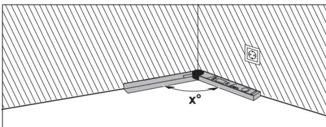
Če želite obdelovance prilagoditi v kot (npr. talne letve), potem izmerite vogalni kot **x°** s prileganjem zložljivega in osnovnega traka. Za vnaprej
