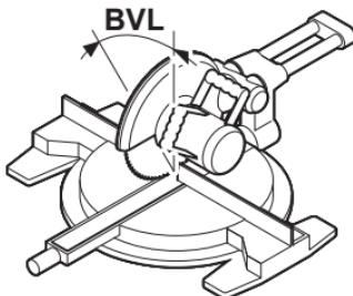
Натиснете отново бутона **COM (7)**. На дисплея се показват **BVL** и изчисленият вертикален ъгъл на скосяване за челния и скосяващ циркуляр. Вертикалният ъгъл на скосяване задава наклона на масата на циркуляра (**BVL**).
