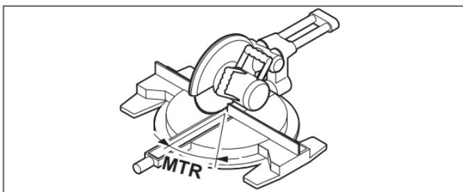
Vēlreiz nospiediet taustiņu **COM (7)**. Uz displeja parādās indikators **MTR** un aprēķinātā horizontālā slīpuma leņķa vērtība, kas jāiestata leņķzāgim/slipzāgim. Horizontālā slīpuma leņķa (**MTR**) vērtība kalpo leņķzāga/slipzāga galda pagriešanas leņķa (horizontālā zāgēšanas leņķa) iestatīšanai.
