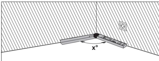
Якщо заготовки треба припасувати в куті (напр., у випадку підлогових плинтусів), тоді виміряйте кутовий кут **x°**, приклавши складане та основне плече. Для заданих кутів (напр., рамки для картин) розведіть складане та основне плече настільки, щоб на дисплеї з'явилось потрібне значення кута.
