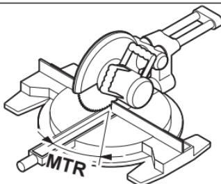
Znova stlačte tlačidlo **COM (7)**. Na displeji sa zobrazia **MTR** a vypočítaný horizontálny uhol zošikmenia pre kapovaciu a pokosovú pílu. Pomocou horizontálneho uhlá zošikmenia sa určuje otočenie rezacieho stola (**MTR**).
