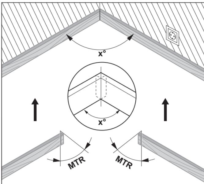
Ekkor kiszámításra kerül a **MTR** („Miter Angle”: vízszintes sarkalószög), amennyivel le kell rövidíteni a két munkadarabot. Ennél a sarokvágásnál a fűrészlap a munkadarabra merőlegesen áll (a függőleges sarkalószög  $0^\circ$ ).
