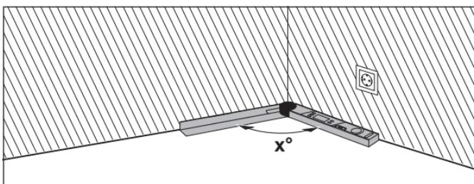
Ak je nutné obrobky prispôsobiť rohu (napr. pre podlahové lišty), zmerajte rohový uhol **x°** priložením sklopacieho a základného ramena. Pri vopred danom uhle (napr. rámy obrazov) otvorte sklopacie a základné rameno tak, aby sa na displeji zobrazil požadovaný uhol.
