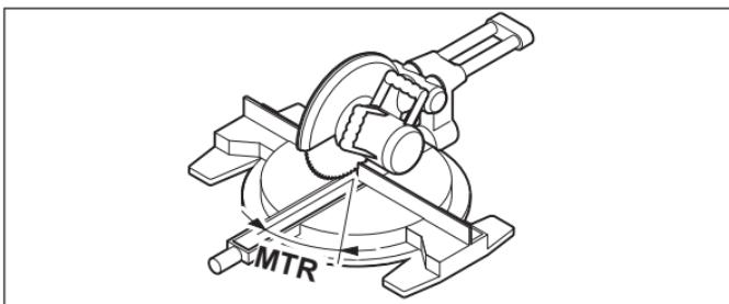
Знову натисніть на кнопку **COM (7)**. На дисплеї відображається **MTR** і розраховане значення горизонтального кута розпилювання для торцювально-вусорізної пилки. За допомогою горизонтального кута скосу задається поворот стола (**MTR**).
