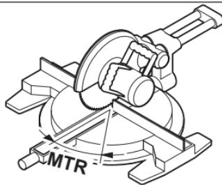
Притиснете го копчето **MTR (8)**. Сè додека го држите притиснатото копчето **MTR (8)** ќе се прикажува пресметаниот хоризонтален агол на закосување **MTR**, кој мора да се постави на пилата за отсекување и сечење под агол. Истовремено светнува индикаторот **MTR** на екранот.
