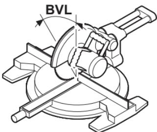
Одново притиснете го копчето **COM (7)**. На екранот се појавуваат **BVL** и пресметаниот вертикален агол на закосување за пилата за отсекување и сечење под агол.
