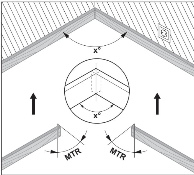
Obliczany jest poziomy kąt cięcia **MTR** („Miter Angle”: poziomy kąt cięcia), o który obrabiane elementy muszą zostać skrócone. Tarczę należy przy tego typu cięciach ustawać pionowo do obrabianego elementu (pionowy kąt cięcia powinien wynosić  $0^\circ$ ).
