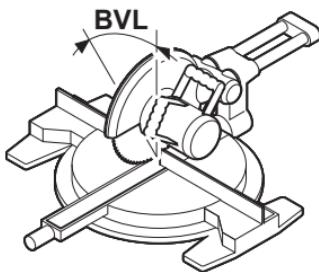
**СОМ (7)** түймесін қайтадан басыңыз. Дисплейде **BVL** индикациясы мен дөңбек және бұрыштық ара үшін өлшенген тік еңіс бұрыши көрсетіледі. Тік еңіс бұрышының көмегімен ара дискісінің еңісі анықталады (**BVL**).
