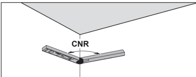
Přiložte sklopné rameno a rameno základny pro změření úhlu rohu plošně ke stěnám a nastavte na měřicím přístroji známý rohový úhel.
