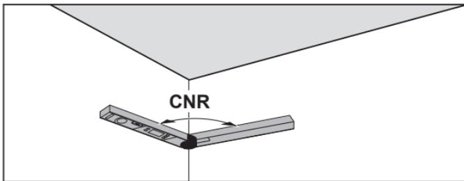
Aby zmierzyć kąt narożnika, należy przyłożyć ramię stałe i ramię ruchome płasko do ścian lub ustawić na urządzeniu pomiarowym znany kąt.
