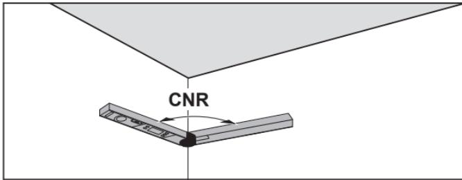
Așază brațul mobil și brațul fix pentru măsurarea unghiului de colț în poziție orizontală pe pereți sau regleză un unghi de colț cunoscut la aparatul de măsură.
