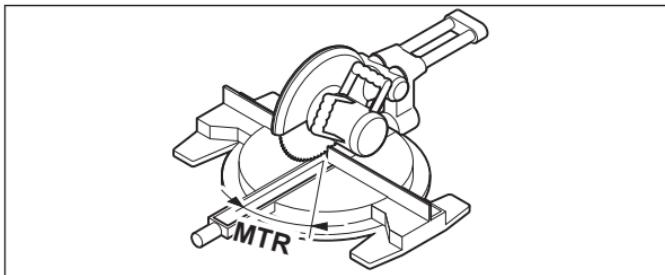
Нажмите на кнопку **MTR (8)**. Пока нажата кнопка **MTR (8)**, будет отображаться рассчитанный горизонтальный угол скоса **MTR**, который нужно настроить на торцовочно-усорезной пиле. Одновременно на дисплее загорается индикатор **MTR**.
