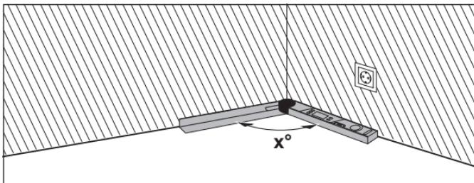
Ukoliko radni komadi treba da se prilagode čošku (npr. za podne lajsne), postavljanjem sklopivog i osnovnog kraka izmerite ugao čoška  $x^\circ$ . Za zadate uglove (npr. ramovi za slike) otvarajte sklopivi i osnovni krak sve dok se na displeju ne prikaže željeni ugao.
