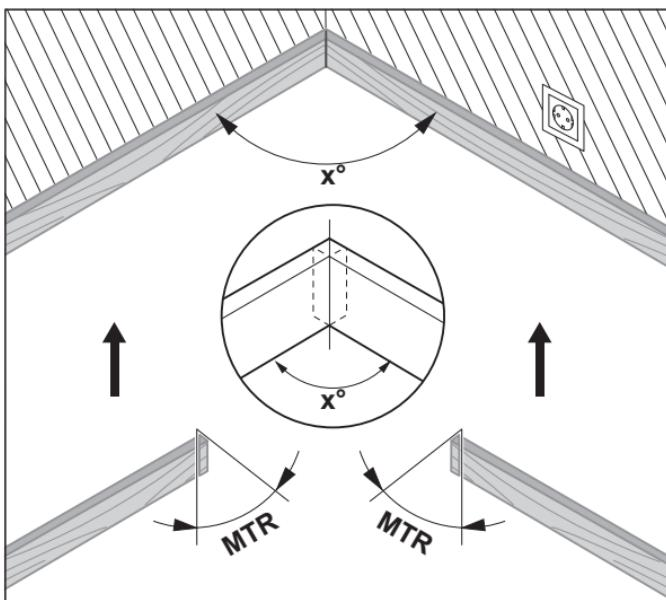
Utvrđuje se horizontalni ugao iskošenja **MTR** („Miter Angle“: horizontalni ugao iskošenja), za koji se dva radna komada moraju skratiti. Kod ovih
