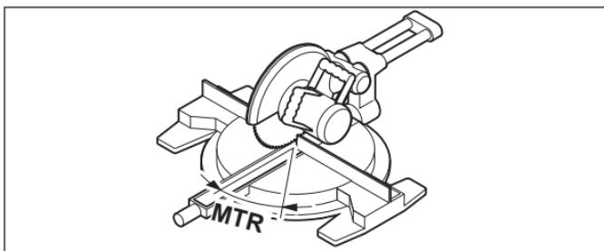
Apasă tasta **MTR (8)**. Atât timp cât menții apăsată tasta **MTR (8)**, este afișat unghiul de îmbinare pe colț în plan orizontal calculat **MTR** care trebuie reglat la ferăstrăul de retezat și pentru îmbinări pe colț. Simultan, pe afișaj se aprinde indicatorul **MTR**.
