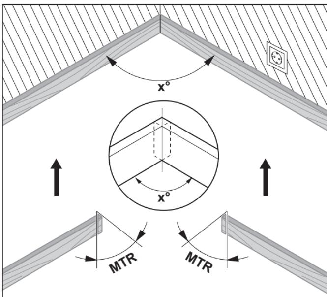
Lai abus priekšmetus varētu savienot vēlamajā leņķi, jāaprēķina horizontālais slipuma leņķis **MTR**, ar kuru jaapzāgē abi savienojamie priekšmeti. Šajā gadījumā zāģa asmenim jāatrodas stateniskā stāvoklī attiecībā pret zāģējamo priekšmetu (vertikālajam zāģēšanas leņķim jābūt  $0^\circ$ ).
