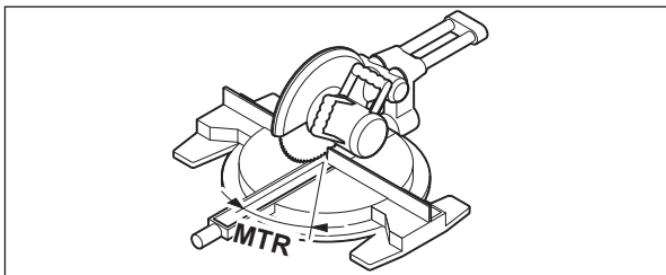
Одново притиснете го копчето **COM (7)**. На екранот се појавуваат **MTR** и пресметаниот хоризонтален агол на закосување за пилата за отсекување и сечење под агол. Со помош на хоризонталниот агол на закосување ќе се утврди вртењето на масата за пила (**MTR**).
