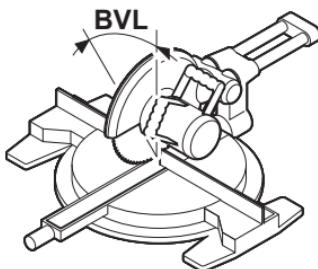
Nyomja meg ismét a **COM (7)** gombot. A kijelzőn megjelenik a **BVL** kijelzés és a számított függőleges sarkalószög a rövidítő és sarkaló fűrész számára. A függőleges sarkalószög alkalmazásával meghatározásra kerül a fűrészlap dölléssége (**BVL**).
