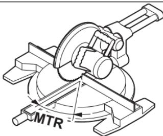
Pritisnite tipku **MTR (8)**. Sve dok držite pritisnutu tipku **MTR (8)**, prikazuje se izračunati horizontalni kut kosog rezanja **MTR** koji treba namjestiti na preklopnoj pili. Istovremeno svijetli pokazivač **MTR** na raspoloživoj strani.
