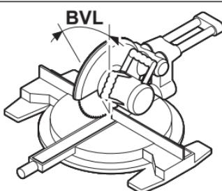
Znova pritisnite tipko **COM (7)**. Na zaslonu se prikažeta **BVL** in izračunan navpični zajeralni kot za čelilno in zajeralno žago.
