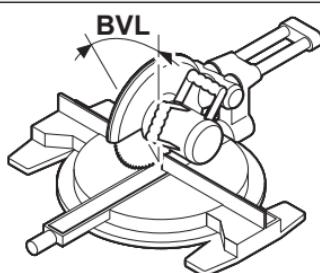
Znovu stiskněte tlačítko **COM (7)**. Na displeji se zobrazí **BVL** a vypočítaný svislý pokosový úhel pro kapovací a pokosovou pilu.
