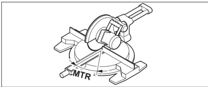
Apasă din nou tasta **COM (7)**. Pe afișaj sunt prezentate **MTR** și unghiul de îmbinare pe colț în plan orizontal calculat pentru ferăstrăul de retezat și pentru îmbinări pe colț. Cu ajutorul unghiului de îmbinare pe colț în plan orizontal se stabilește rotirea mesei de lucru pentru ferăstrău (**MTR**).
