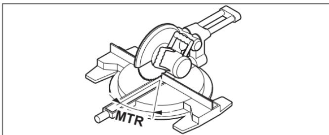
Nyomja meg ismét a **COM (7)** gombot. A kijelzőn megjelenik a **MTR** kijelzés és a számított vízszintes sarkalószög a rövidítő és sarkaló fűrész számára. A vízszintes sarkalószög alkalmazásával meghatározásra kerül a fűrészszájt elfordulási szöge (**MTR**).
