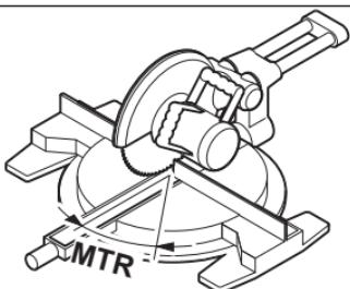
Pritisnite tipko **MTR (8)**. Dokler držite pritisnjeno tipko **MTR (8)**, bo prikazan izračunan vodoraven zajeralni kot **MTR**, ki ga je treba nastaviti na čelilin in zajeralni žagi. Obenem sveti indikator **MTR** na zaslonu.
