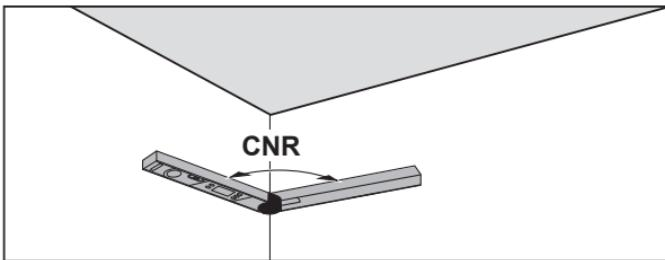
Для вимірювання кутового кута покладіть складне і базове плече всією поверхнею до стіни або налаштуйте відомий кутовий кут на вимірювальному інструменті.
