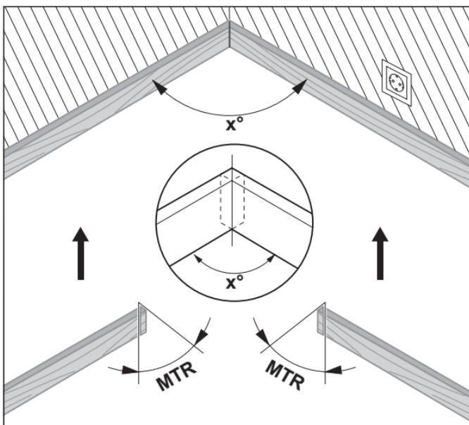
Визначається горизонтальний кут розпилювання **MTR** («Miter Angle»: горизонтальний кут розпилювання), на який повинні бути підрізані заготовки. При цих кутах розпилювання пиллярний диск знаходиться перпендикулярно до заготовки (вертикальний кут розпилювання складає  $0^\circ$ ).
