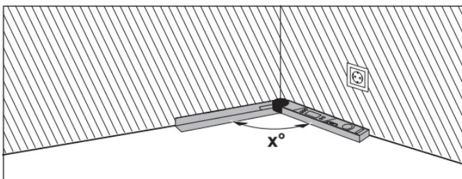
Ha a munkadarabokat egy sarokba kell beilleszteni (például padlólécékhez), akkor a kihajtható és az alapszár felhelyezésével mérje meg a  $x^\circ$  sarokszöget. Egy adott szögértékhez (például képeret) nyissa szét annyira a kihajtható és az alapszárat, hogy a kívánt szögérték kerüljön kijelzésre.
