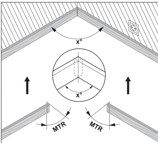
Vypočítá se vodorovný pokosový úhel **MTR** („Miter Angle“: vodorovný pokosový úhel), o který se musí dva obrobky zkrátit. Pilový kotouč je u těchto pokosových rezů kolmo k obrobku (svislý pokosový úhel činí  $0^\circ$ ).
