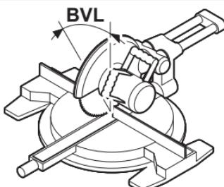
Vajutage uuesti nuppu **COM (7)**. Ekraani kuvatakse **BVL** ja arvutatud vertikaalne kaldlöikenurk jätkamis- ja kaldlökesaagidele.
