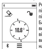
Режим вимірювання кута нахилу слугує для визначення підйому або нахилу (напр., сходових хіднів, поручнів, при підгонці меблів, при прокладанні труб тощо).
