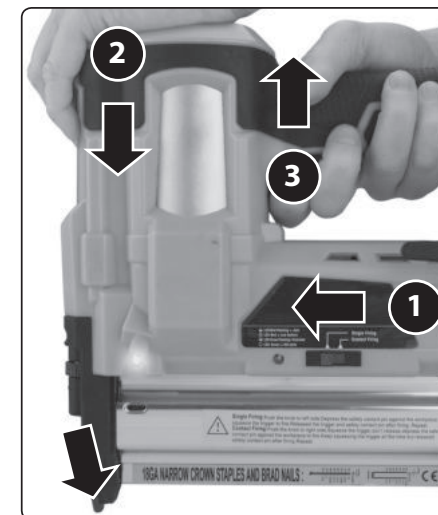
Abb. 4, Einzelschussmodus (selektives Kontaktauslösen)
