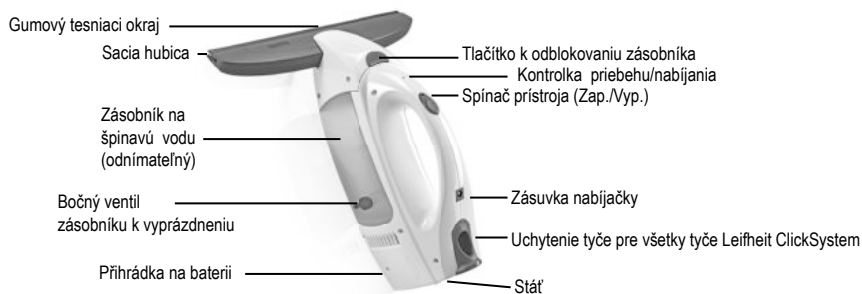
Obrázok 2: Obslužné prvky okenej odsávačky
