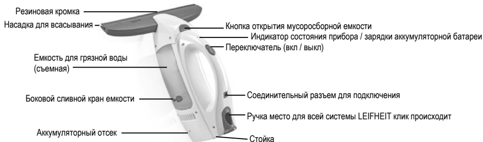
Рисунок 2: Элементы управления оконным пылесосом
