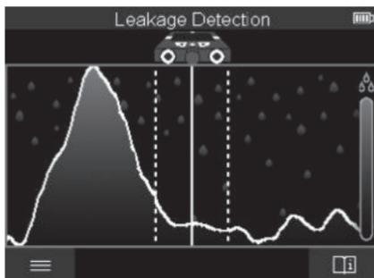
Ebben a mérési üzemmódban a felület relatív anyagnedvessége kerül kijelzésre. Ezért ez a mérési üzemmód a maximális anyagnedvesség helyének és ezzel egy esetleges szivárgás helyének meghatározására alkalmas.
