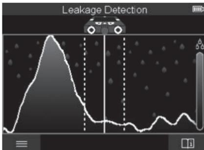
У цьому режимі вимірювання відображається відносна вологість матеріалу поверхні. Тож цей режим підходить для визначення зони максимальної вологості матеріалу і відповідно місця можливого витоку.
