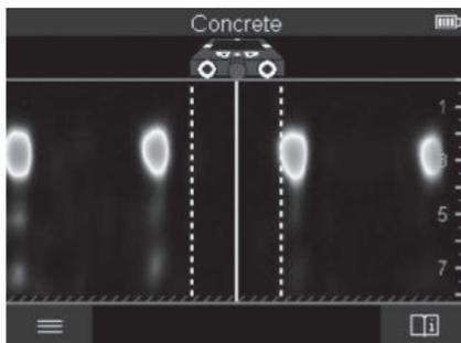
На **<Преглед на сигнали 2D>** се прикажува јачината на сигналот на соодветната мерна позиција во комбинација со длабочината на предметот. **<Преглед на сигнали 2D>** е варијанта на **<Преглед на предмети>**. Ова покажува јачина на сигнал наместо ознаки на предмет. Максималната јачина на сигнал го претставува горниот раб на предметот.
