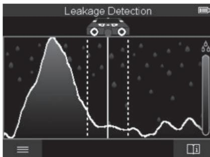
V tomto režimu měření se zobrazuje relativní vlhkost materiálu povrchu. Proto je vhodný k lokalizaci místa s maximální vlhkostí materiálu, a tedy případné netěsnosti.
