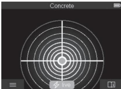
V náhledu **<Přímý náhled>** se zobrazí už první výsledek měření, aniž by se pohybovalo měřicím přístrojem po podkladu. Je proto vhodný zejména pro měření v rozích nebo na úzkých místech. Maximální hloubka měření činí 6 cm. Nalezené objekty se případně zobrazí s vlastnostmi materiálu, ale bez uvedení hloubky.
