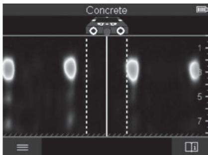
В **<Вид сигнала 2D>** отображается уровень сигнала в соответствующей позиции измерения вместе с глубиной залегания объекта. **<Вид сигнала 2D>** – вариант **<Вид объекта>**. В этом виде отображается уровень мощности сигнала вместо символа объекта. Максимальная мощность сигнала служит для обозначения верхнего края объекта.
