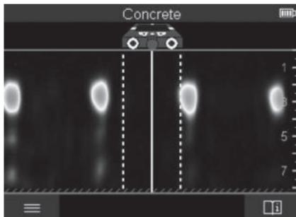
A **<Jelnézet 2D>** mérési eljárás során a mindenkor mérési helyzetben fennálló jelerősség a tárgymélységgel együtt kerül kijelzésre. A **<Jelnézet 2D>** a **<Tárgynézet>** egy változata. Ebben a nézetben a tárgyszimbólumok helyett jelerősségek kerülnek kijelzésre. A maximális jelerősség a tárgyak felső peremét jelzi.
