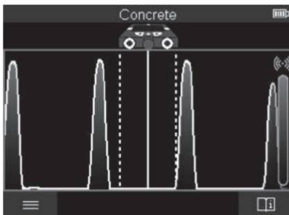
**<Signal View>** pokazuje siłę sygnału w danej pozycji pomiarowej bez informacji o głębokości położenia obiektu.
