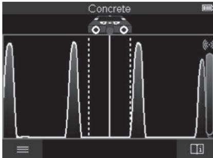
В **<Просмотр сигнала>** отображается уровень сигнала в соответствующей позиции измерения без данных о глубине залегания объекта.
