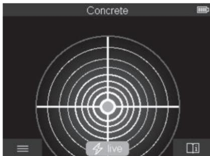
В <Точков изглед> се показва първи резултат от измерването без измервателният уред да се премества над основата. Ето защо той е подходящ за измервания в ъгли или на тесни места. Максималната дълбочина на измерване е 6 см. Откритите обекти се показват със свойството на материала, но без посочване на дълбочина.
