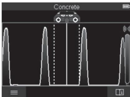
A **<Jelnézet>** mérési eljárás során a mindenkor mérési helyzetben fennálló jelerősség a tárgymélységre vonatkozó információ nélkül kerül kijelzésre.
