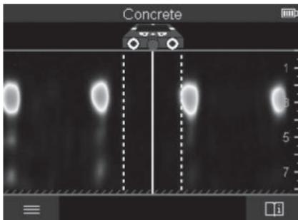
**<Signal View 2D>** pokazuje siłę sygnału w danej pozycji pomiarowej w połączeniu z głębokością położenia obiektu. **<Signal View 2D>** jest wariantem **<Widok obiektu>**.
