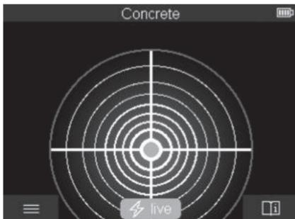
A <Pontnézet> foltnézetben egy első mérési eredmény már akkor kijelzésre kerül, amikor a mérőműszert még el sem kezdte mozgatni az alap felett. Ezért ez nézet különösen jól alkalmazható sarkokban vagy más, szűk helyeken végzett mérésekhez. A maximális
