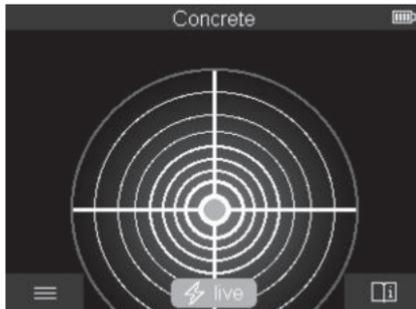
У **<Вид точки>** відображається перший результат вимірювання без переміщення вимірювального інструмента над основою. Тому такий вид особливо добре підходить для вимірювань в кутах або у вузьких місцях. Максимальна глибина вимірювання становить 6 см. Виявлені об'єкти відображаються з інформацією про властивості матеріалу, але без даних про глибину знаходження.
