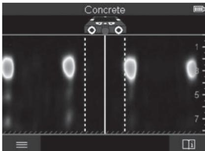
U <Prikaz signala 2D> prikazuje se jačina signala na odgovarajućem mjernom položaju u kombinaciji s dubinom predmeta. <Prikaz signala 2D> je varijanta <Prikaz objekta>. Prikazuje jačine signala umjesto simbola predmeta. Maksimalna jačina signala prikazuje gornji rub predmeta.
