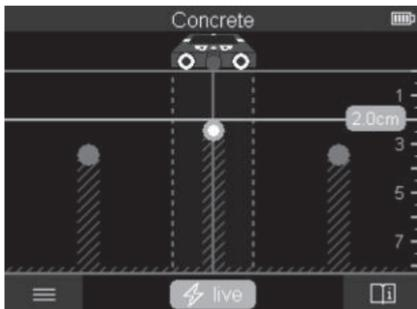
V **<Náhled objektu>** jsou k dispozici nejlepší možné výsledky měření a maximální hloubky měření. Rozpoznané objekty se zobrazí na měřicí dráze s údajem hloubky a případně s vlastností materiálu.
