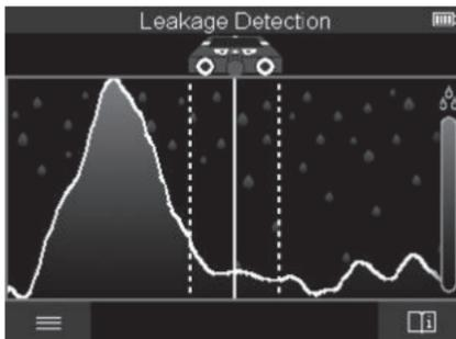
В этом режиме измерения отображается относительная влажность материала поверхности. Таким образом, данный режим подходит для определения зоны максимальной влажности материала и, соответственно, места возможной утечки.
