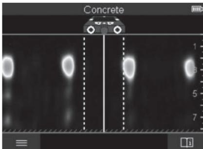
U **<Prikaz signala 2D>** se prikazuje jačina signala na dotičnom položaju merenja u kombinaciji sa dubinom objekta. **<Prikaz signala 2D>** je varijanta **<Prikaz objekta>**. Ona prikazuje jačine signala umesto simbola objekta. Maksimalna jačina signala predstavlja gornju ivicu objekta.
