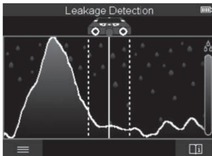
W tym trybie pomiaru wskazywana jest wilgotność względna materiału, z jakiego wykonana jest powierzchnia. Dlatego tryb ten jest odpowiedni do wskazywania miejsc o maksymalnej wilgotności oraz lokalizacji możliwego przecieku.
