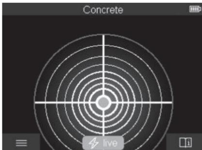
U **<Prikaz točke>** već se prikazuje prvi rezultat mjerenja bez pomicanja mjernog alata iznad podloge. Stoga je posebno prikladan za mjerenja u kutovima ili na uskim mjestima. Maksimalna dubina mjerenja iznosi 6 cm. Eventualno se pronađeni predmeti prikazuju sa svojstvom materijala, ali bez navođenja dubine.
