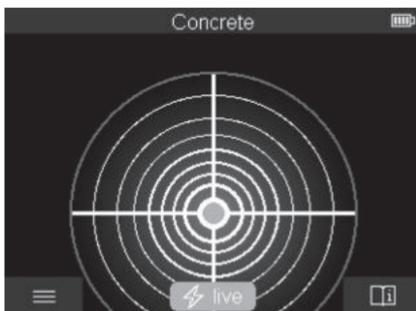
В **<Точечный вид>** отображается первый результат измерения без перемещения измерительного инструмента над основанием. Поэтому такой вид особенно хорошо подходит для измерений в углах или в узких местах. Макс. глубина измерения составляет 6 см. Обнаруженные объекты отображаются с информацией о свойствах материала, но без данных о глубине залегания.
