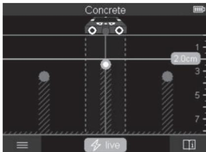
**<Widok obiektu>** zapewnia optymalne rezultaty oraz maksymalne głębokości detekcji. Wykrywane obiekty są wskazywane wraz z podaniem głębokości w całym zakresie pomiaru oraz ew. z podaniem właściwości materiału.
