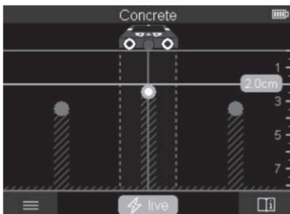
В **<Вид объекта>** можно получить наилучший из возможных результат измерения при максимальной глубине измерения. Обнаруженные объекты отображаются над участком измерения вместе с данными о глубине и, при необходимости, со свойствами материала.
