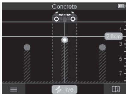
У **<Вид на об'єкт>** можна отримати найкращий з можливих результат вимірювання при максимальній глибині вимірювання. Виявлені об'єкти відображаються над ділянкою вимірювання разом з даними про глибину і за потреби з властивостями матеріалу.
