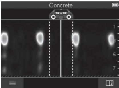
В **<Изглед на сигнала 2D>** се показва силата на сигнала върху съответната позиция на измерване в комбинация с дълбочината на обекта. **<Изглед на сигнала 2D>** е вариант на **<Изглед на обект>**. Той показва силите на сигнала вместо символи на обекти. Максималната сила на сигнала представлява горния ръб на обектите.
