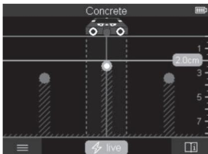
В **<Изглед на обект>** на разположение са възможно най-добрите резултати от измерването и максималните дълбочини на измерване. Разпознатите обекти се показват през измервателната отсечка с посочване на дълбочина и при нужда със свойството на материала.
