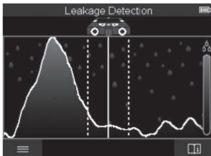
В този режим на измерване се показва относителната влажност на материала на повърхността. Той е подходящ за локализирането на мястото на максимална влажност на материала и съответно на евентуалните течове.
