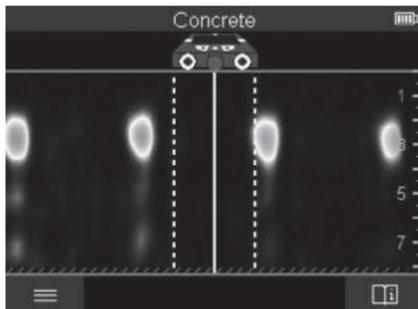
У режимі **<Видимість сигналу 2D>** відображається потужність сигналу у відповідній позиції вимірювання разом з глибиною знаходження об'єкта. **<Видимість сигналу 2D>** є варіантом для **<Вид на об'єкт>**. У цьому режимі відображається потужність сигналу замість символу об'єкта. Максимальна потужність сигналу являє собою верхній край об'єктів.
