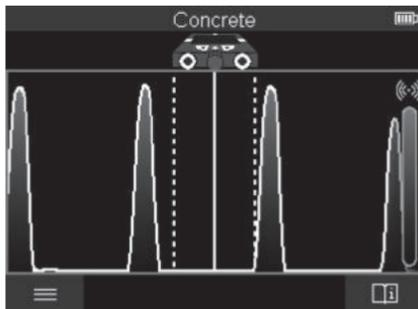
В **<Изобразяване на сигнала>** се показва силата на сигнала върху съответната позиция на измерване без информация за дълбочината на обекта.
