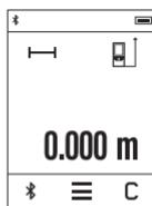
Ob vklopu je merilna naprava nastavljena na funkcijo merjenja razdalje. Druge merilne funkcije lahko nastavite z večkratnim pritiskom tipke (k) (glejte „Merilne funkcije“, Stran 221). Referenčna točka za meritev po vklopu je zadnji rob merilne naprave. S pritiskom tipke (e) lahko spremenite referenčno točko (glejte „Izbira referenčne točke (glejte slike A–C)“, Stran 220).
