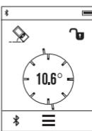
Kalde mõõtmise on ette nähtud tõusu või kalde mõõtmiseks (nt treppidel, käspuuadel, mööbli sobitamisel, torude paigaldamisel jms). Kalde mõõtmisel on lähtetasandiks mõõteseadme vasakpoolne külg. Kui ekraanil ei kuvata ühtege kaldenurka, on mõõteseadeid mõõtmise ajal liiga suures ulatustes küljele kallutatud.
