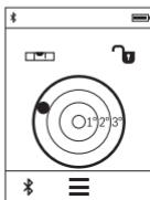
Digitalna vodna tehnica se uporablja za preverjanje istočasne vodoravne poravnanoosti objekta na dve osi (npr. pralnega stroja, hladilnika itd.).
