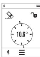
Режим вимірювання кута нахилу слугує для визначення підйому або нахилу (напр., сходових хіднів, поручнів, при підгонці меблів, при прокладанні труб тощо).
