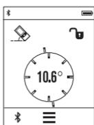
Měření sklonu slouží k měření stoupání nebo klesání (např. schodišť, zábradlí, při přizpůsobování nábytku, při pokládání trubek).
