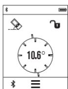
Мерењето на косини служи за мерење на нагорнини и надолнини (на пр. на скали, геленди, при вклопување на мебел, при положување на цевки итн.).
