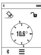
Funkcja pomiaru nachylenia służy do mierzenia wzniesień i nachyleń (np. schodów, poręczy, podczas dopasowywania mebli, przedłużania rur itp.).
