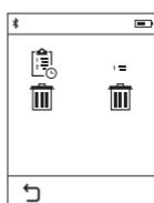
Po stisknutí tlačítka **(h)** můžete smazat celý seznam naměřených hodnot nebo jednotlivé naměřené hodnoty. Stisknutím tlačítka **(h)** se příslušná vybraná jednotlivá naměřená hodnota smaže.
