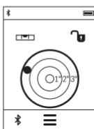
Цифровата либела служи за проверка на хоризонталното подравняване на обект едновременно спрямо две оси (напр. пералня, хладилник и др.).
