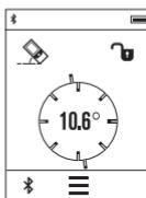
Режим измерения наклона служит для измерения подъема или уклона (напр., лестничных пролетов, лестничных площадок, при подгонке мебели, при прокладке труб и т.д.).
