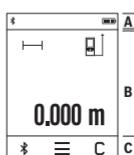
Дисплей поділяється на зони рядка стану (A) і сенсорного дисплея (B) з рядком меню (C). У рядку стану вказується стан з'єднання *Bluetooth®*, температурне попередження і стан заряду батарейок/акумуляторних батарей. Вимірювальним інструментом можна керувати за допомогою натискання кнопок на сенсорному дисплеї.
