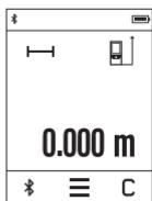
Після увімкнення вимірювальний інструмент знаходиться в режимі вимірювання довжини. Інші режими вимірювання можна налаштувати багаторазовим натисканням на кнопку **(k)** (див. „Функції вимірювання“, Сторінка 109).
