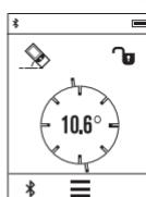
Meranie sklonu slúži na meranie stúpania alebo sklonu (napr. schodov, zábradlia, pri prispôsobení nábytku, pri pokladaní rúr atď.). Ako referenčná rovina pre meranie sklonu slúží ľavá strana meracieho prístroja. Ak sa na displeji nezobrazuje žiadnen uhol sklonu, bol merací prístroj počas merania príliš nahnutý na stranu.
