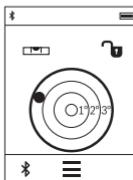
Цифровой ватерпас служит для проверки горизонтальности положения объекта по двум осям одновременно (напр., стиральной машины, холодильника и т.д.).
