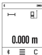
Po zapnutí se měřicí přístroj nachází ve funkci měření délky. Ostatní funkce měření můžete nastavit stisknutím tlačítka **(k)** (viz „Měřicí funkce“, Stránka 33).
