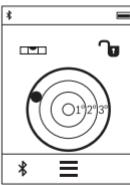
Digitaalset vesiloodi kasutatakse objekti (nt pesumasina, külmkapi jms) horisontaalse joondamise kontrolliks korraga kahe telje suunas. Digitaalse vesiloodi lähtetasandiks on mõõteseadme tagakülg. Hetkelist mõõteväärust saate mõõtenuppu **(1)** või nuppu vajutades ekraanil säilitada.
