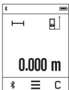
Қосылғаннан кейін өлшеу құралы үзындық өлшеу функциясында тұрады. Басқа өлшеу функциялары (k) түймесін басу арқылы реттеуге болады (қараңыз „Өлшеу функциялары“, Бет 129).
