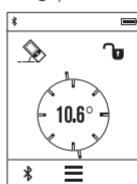
Măsurarea înclinării permite măsurarea unei pante sau înclinări (de exemplu, a scărilor, balustradelor, potrivirea pieselor de mobilier, la montarea țevilor etc.).
