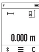
Po włączeniu urządzenie automatycznie ustawia się w funkcji pomiarów długości. Pozostałe funkcje pomiarowe można wybrać, naciskając przycisk **(k)** (zob. „Funkcje pomiarowe“, Strona 15).
