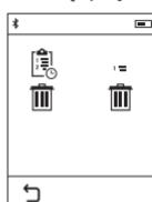
Po wybraniu przycisku **(h)** można usunąć albo całą listę wartości pomiarowych, albo poszczególne wartości. Naciśnięcie przycisku **(h)** powoduje usunięcie aktualnie wybranej wartości pomiarowej.
