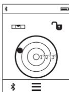
Дигиталната либела служи за проверка на хоризонталното израмнување истовремено на две оски на еден објект (на пр. машина за перење, фрижидер итн.).
