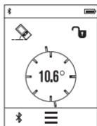
Nolieces mērišana ir pielietojama, lai izmērītu objektu stāvumu vai nolieci (piemēram, uzstādot kāpnes vai kāpņu margas, salāgojot mēbeles, ieguldot caurules u.c.).
