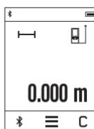
Pärast sisselülitamist on mööteseade pikkuse möötmise funktsioonil. Teisi möötmisfunktsioone saate seada, vajutades nuppu (**k**) (vaadake „Möötefunktsoonid“, Lehekülg 256). Sisselülitamise järel on möötmise lähtetasandiks mööteseade tagaserv. Vajutades nuppu (**e**), saate lähtetasandit muuta (vaadake „Lähtetasandi valimine (vaata jooniseid **A–C**)“, Lehekülg 255). Möötmiseks asetage mööteseade valitud lähtetasandiga soovitud stardipunkti (nt seinale).
