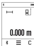
Tūlit pēc ieslēgšanas mērinstruments sāk darboties garuma mērišanas režimā. Pāriet uz citiem mērišanas režīniem var, nospiežot taustiņu **(k)** (Mērišanas režīmi) (skatīt „Mērišanas režīmi“, Lappuse 273).
