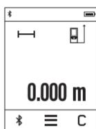
После включения измерительный инструмент находится в режиме измерения длины. Другие режимы измерения можно настроить многократным нажатием на кнопку **(k)** (см. „Режимы измерений“, Страница 89).
