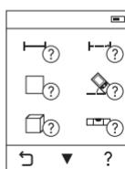
Każdej funkcji pomiarowej urządzenia pomiarowego towarzyszy instrukcja w postaci animacji. W pierwszej kolejności należy wybrać przycisk (k), a następnie żądaną funkcję pomiarową. Animacja przedstawia dokładny sposób postępowania dla danej funkcji pomiarowej. Animację można w każdej chwili zatrzymać i ponownie uruchomić. Istnieje możliwość przewijania do przodu i do tyłu.
