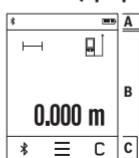
Zaslon je podijeljen u područja: na statusnu traku (A) i zaslon osjetljiv na dodir (B) s trakom izbornika (C).
