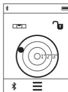
Digitálna vodováha slúži na kontrolu horizontálneho alebo vertikálneho vyrovnania objektu na dvoch osiach súčasne (napr. práčky, chladničky atď.).
