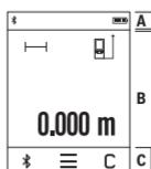
Wyświetlacz składa się z trzech części: paska stanu (A) oraz z ekranu dotykowego (B) wraz z paskiem menu (C). Na pasku stanu wyświetlony jest status połączenia Bluetooth®, alarm temperatury oraz stan naładowania baterii/akumulatorów. Sterowanie urządzeniem pomiarowym odbywa się za pomocą przycisków na ekranie dotykowym.
