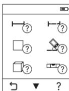
В измерительном инструменте для каждого режима измерения имеется помощь в виде анимации. Сначала нажмите кнопку **(k)**, а затем желаемый режим измерения. Анимация наглядно показывает способ действия для выбранного режима измерения. Анимацию можно в любой момент остановить и начать сначала. Можно также прокручивать ее вперед или назад.
