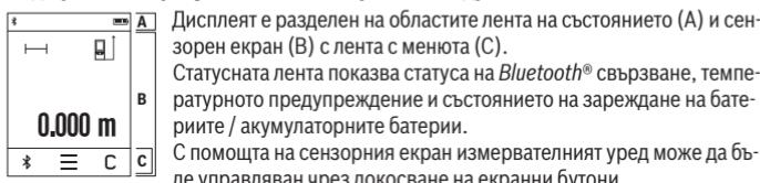
Лентата с менютата предоставя достъп до допълнителни функции (напр. включване и изключване на *Bluetooth*<sup>®</sup>, менюта, изтрядане).
