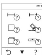
Измервателният уред има анимирана помощ за всеки режим на измерване. Първо изберете бутона **(k)**, а след това желаната функция за измерване. Анимацията показва подробно стъпките за избраната функция.
