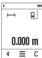
По вклучувањето, мерниот уред се наоѓа во функција на должинско мерење. Другите мерни функции може да ги поставите со притискање на копчето **(k)** (види „Мерни функции“, Страница 186).
