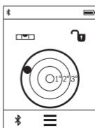
Nivela digitală cu bulă de aer permite verificarea alinierii simultane pe două axe ale unui obiect (de exemplu, mașină de spălat, frigider și.a.m.d.).
