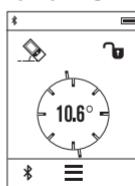
A lejtésmérés (például lépcsők, korlátok, egymáshoz illesztendő bútorok, csövek lefektetésekor stb.) egy menetemelkedés vagy lejtés mérésére szolgál.
