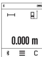
След включване измервателният уред се намира в режим за измерване на дължини. Други измервателни функции можете да настройвате чрез натискане на бутона **(k)** (вж. „Функции за измерване“, Страница 167).
