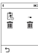
Натисненням кнопки **(h)** можна видалити весь список або окремі вимірюні значення. Натисненням кнопки **(h)** можна видалити обране на той час окреме вимірюне значення.
