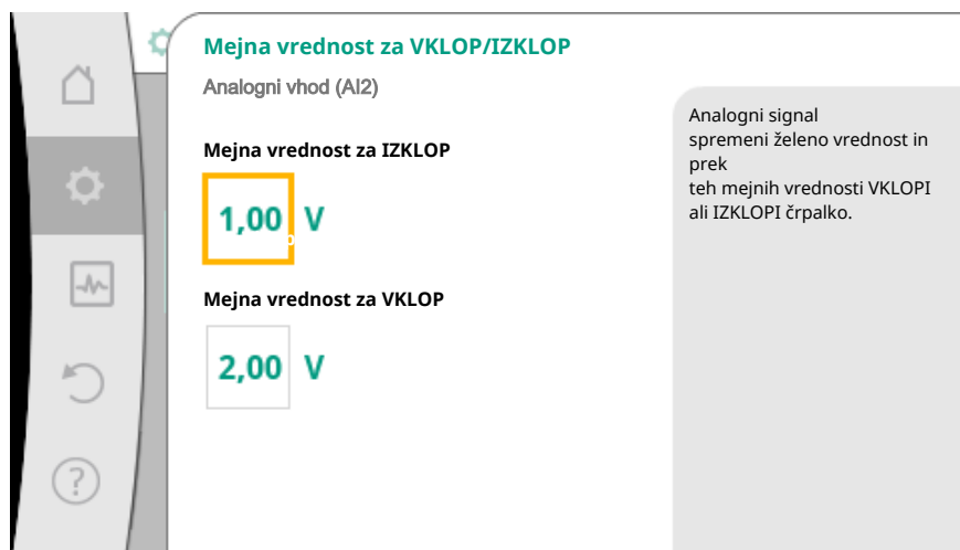
Fig. 74: Mejne vrednosti za krmiljenje VKL./IZKL. prek analognih signalov
