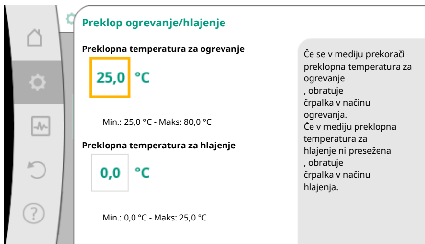
Fig. 57: Preklop ogrevanje/hlajenje_preklopne temperature
