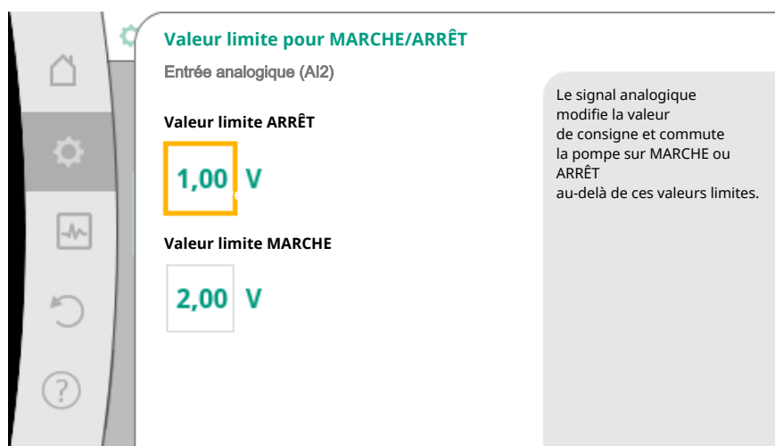
Fig. 74: Valeurs limites de la commande MARCHÉ/ARRÊT via signaux analogiques
