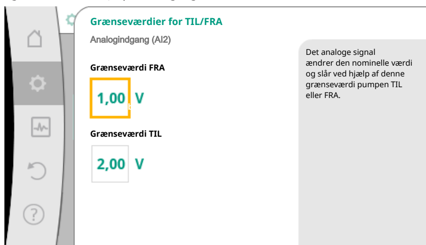
Fig. 74: Grænseværdier til TIL/FRA-styring via analoge signaler
