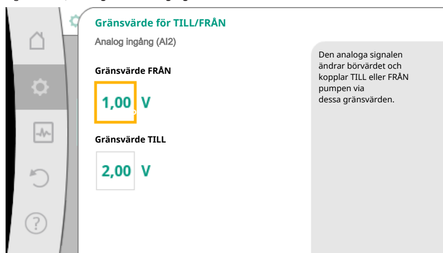
Fig. 74: Gränsvärden för TILL/FRÅN-styrning via analog signal
