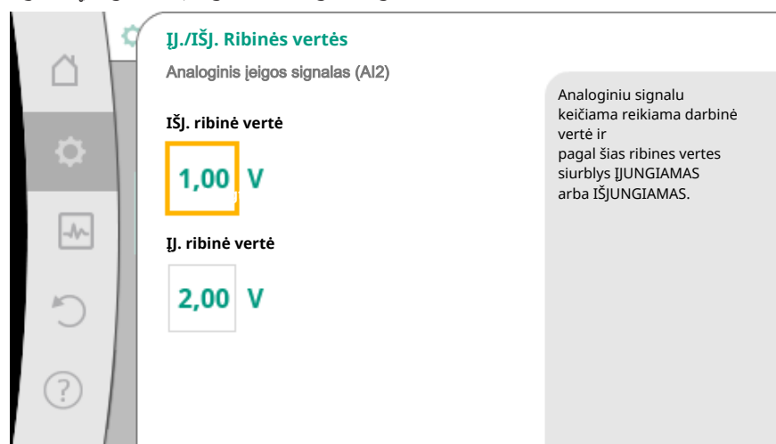
Fig. 74: Įjungimas/išjungimas valdymo analoginiu signalu ribinė vertė
