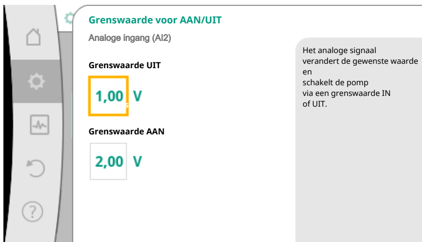
Fig. 74: Grenswaarden voor AAN/UIT-besturing via analoge signalen
