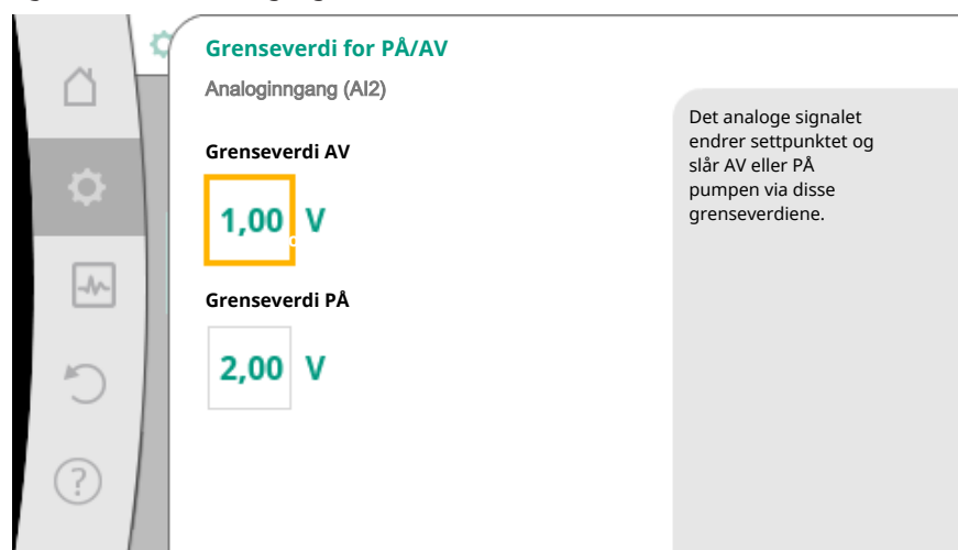
Fig. 74: Grenseverdier for AV/PÅ-styring via analogsignaler
