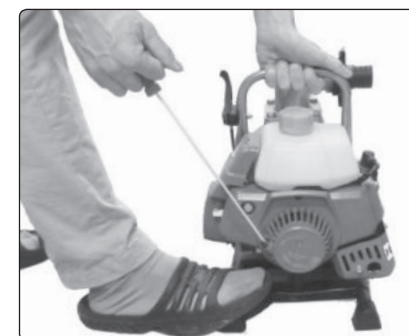
Abb. 6, Starten der Pumpe
