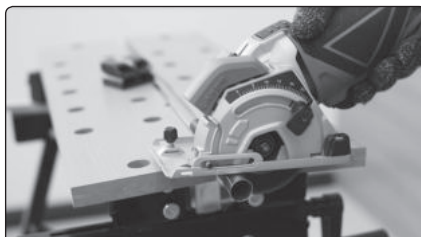
Obr.20, řezání PVC trubky
