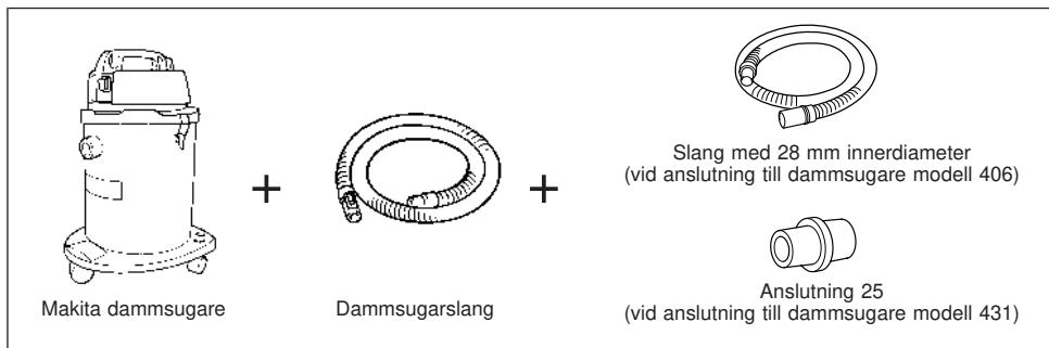
Vid anslutning till en Makita dammupsamlare (modell 420) behövs inte den separata slangen eller anslutningen. Du kan ansluta bandslipmaskinen direkt till dammupsamlarens slang.
