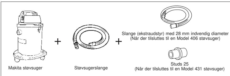
Når der tilsluttes til en Makita støvopsamler (Model 420), er ekstraudstyrsslangen og studsen ikke nødvendige. De kan tilslutte båndsliberen direkte til slangen på støvopsamleren.
