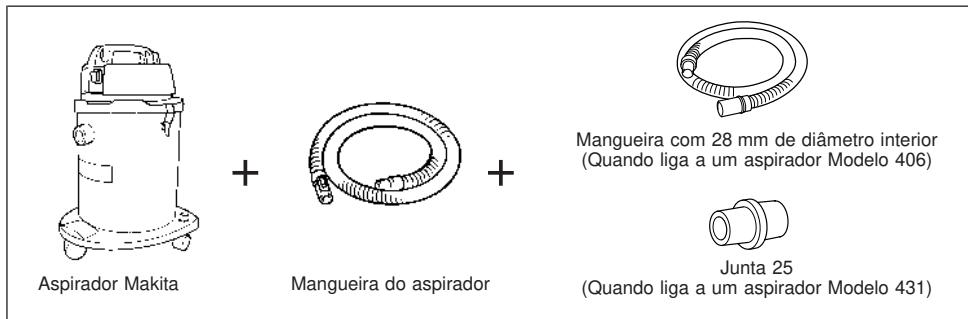
Quando liga ao aspirador Makita Modelo 420 não necessita da mangueira ou junta opcional. Pode ligar a lixadora de braçadeira directamente à mangueira do aspirador.
