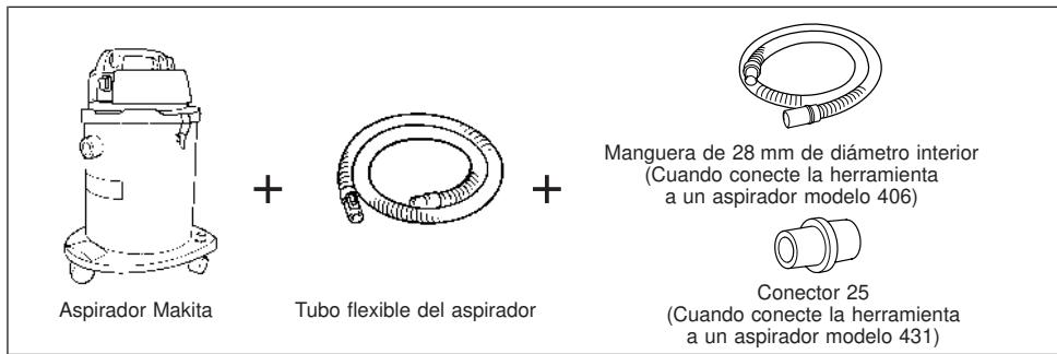
Cuando conecte el aspirador de polvo Makita (Modelo 420), no necesitará el tubo flexible ni el conector opcional. Podrá conectar la lijadora de banda directamente al tubo flexible del aspirador de polvo.
