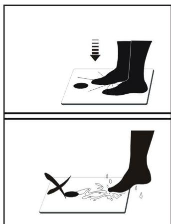
VÁŽI IHNEĎ: na váhu sa stačí postaviť - automaticky dôjde k zapnutiu a zváženiu
