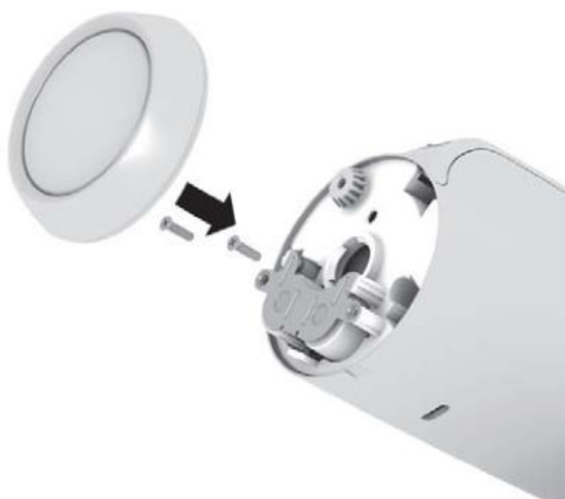
Pružinu baterie lze zajistit šroubkem (ochrana před odcizením baterií, šroubky v balení)
