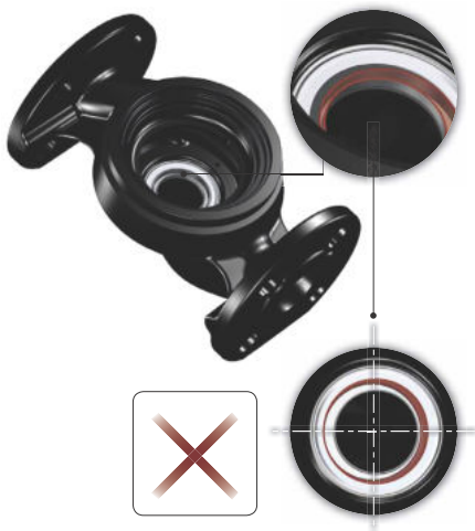
12. ábra Nem megfelelően középre igazított tömítések
