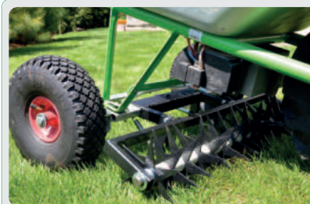
Stabilizační pružiny Upínací rám Fixační šroub upínacího rámu Regulační šroub hloubky vertikutace 0-40 mm Rám s hvězdicemi
