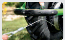
Disk navijáku Ocelové lanko Lanové maticové svorky Karabina
