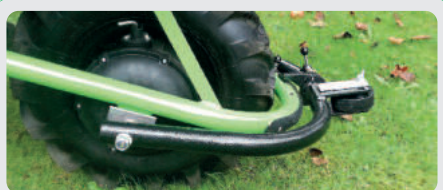
Gumový puk pro snadné vyklápění Aretační západka předního nářadí Západka pracovní polohy držáku Upínací úhelníky pro montáž na Motýčko
