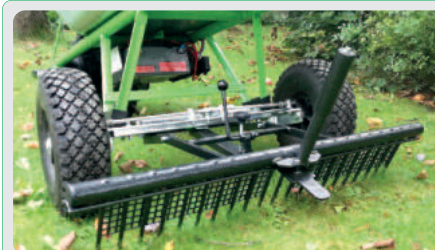
Rám se stěračem Regulační šroub výšky Regulační páka hloubky Fixační šroub upínacího rámu Upínací rám Pouzdro zvedací pružiny Šlapka stěrače
