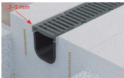
Okolní povrch by měl být trvale 3 až 5 mm nad horní plochou kryty žlabů. Žlab je nutné zabetonovat v celé výšce. Šířka (tloušťka) boční vrstvy betonu je doporučena minimálně 20 cm.
