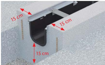
Nastavte výšku tak, aby bylo dosaženo spádování. Aby nedošlo k deformaci žlabu během instalace jsou žlaby opatřeny rozpěrami, které se po zabetonování odstraní.
