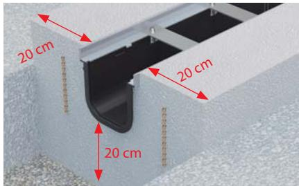
Nastavte výšku tak, aby bylo dosaženo spádování. Aby nedošlo k deformaci žlabu během instalace jsou žlaby opatřeny rozpěrami, které se po zabetonování odstraní.
