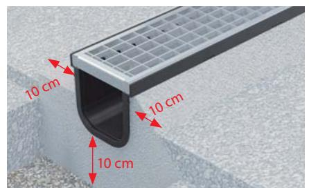
Nastavte výšku tak, aby bylo dosaženo spádování. Žlaby instalujte s vloženými rošty, aby nedošlo k deformaci žlabu během instalace. Aby se zamezilo znečištění roštů, doporučujeme zakrýt rošt PVC fólií.
