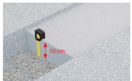
Zvolte místo odtoku (nejnižší místo), začátek a konec linie. Minimální výška betonového podkladu je 10 cm.
