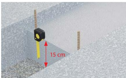
Zvolte místo odtoku (nejnižší místo), začátek a konec linie. Minimální výška betonového podkladu je 15 cm. Do betonového podkladu vložte betonářskou ocel Ø10 mm, každých 40 cm.
