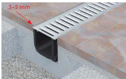
Okolní povrch by měl být trvale 3 až 5 mm nad horní plochou krytů žlabů. V případě použití betonové dlažby pro pojedzdné plochy doporučujeme alespoň krajní řadu této dlažby v těsné blízkosti žlabů uložit do betonového lože.
