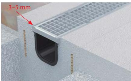
Okolní povrch by měl být trvale 3 až 5 mm nad horní plochou kryty žlabů. Žlab je nutné zabetonovat v celé výšce. Šířka (tloušťka) boční vrstvy betonu je doporučena minimálně 15 cm.
