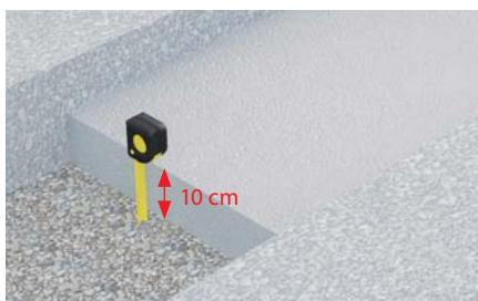
Zvolte místo odtoku (nejnižší místo), začátek a konec linie. Minimální výška betonového podkladu je 10 cm.
