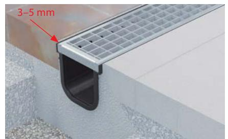
Okolní povrch by měl být trvale 3 až 5 mm nad horní plochou krytů žlabů. V případě použití betonové dlažby pro pojedzdné plochy doporučujeme postupovat dle níže uvedeného schématu.
