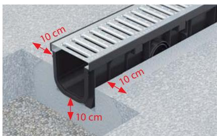
Nastavte výšku tak, aby bylo dosaženo spádování. Žlaby instalujte s vloženými rošty, aby nedošlo k deformaci žlabu během instalace. Aby se zamezilo znečištění roštů, doporučujeme zakrýt rošt PVC fólií.
