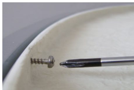
Použít šrouby 4x12 use screws 4x12
