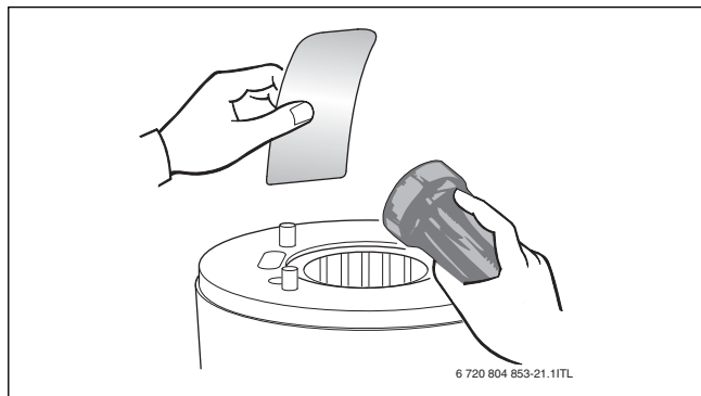
Obr. 44 Kontrola zbytků v tepelném bloku
