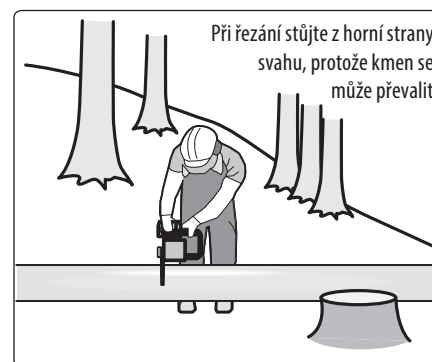
Kmen podepřen na obou koncích, obr. 19
