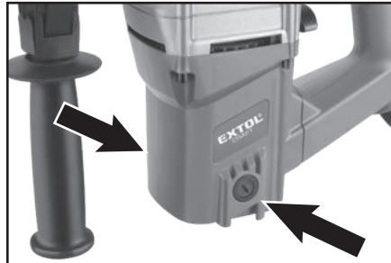
Abdeckung vom Kohlebürstengehäuse beim Bohrhämmer Extol Craft 401232 Abb. 13
