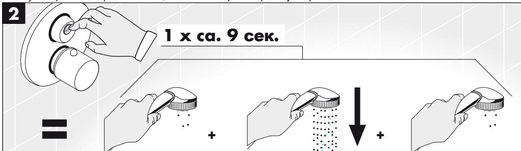
Старт: кнопку "старт - стоп" нажать еще раз и удерживать нажатой до тех пор, пока потребитель самостоятельно не прекратит излив воды, после этого кратковременно опять начнет и потом опять самостоятельно прекратит излив воды. После этого отпустить кнопку "старт - стоп".
