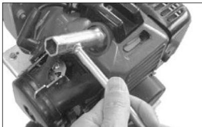
3. Mechanicky očistite nánosy na elektródach, napr. brúsnym papierom alebo ocelovou kefkou. Ak je to nutné, upravte vzdialenosť medzi elektródami na vzdialenosť 0,6 - 0,7 mm pomocou klieští.
