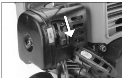
3. Regulátor výkonu / otáčok (Obr.1, pozícia 3) prepnite do polohy MAX.
