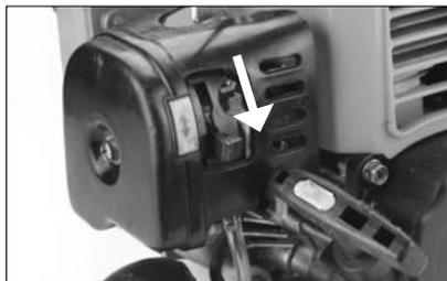
3. Regulátor výkonu/otáček (Obr.1, pozice 3) přepněte do polohy MAX.
