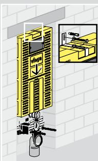
Nasadte předstěnový WC blok VIEGA Mono na WC držák a pomocí vodováhy jej přesně vyrovnejte. Na horním konci jej připevněte hmoždinkou a šroubem. Důležité: nad splachovací nádržkou se musí vsadit betonový překlad.
