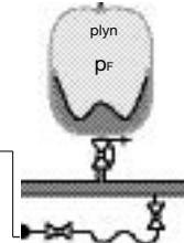
Naplňte expanzní nádobu vodou na tlak  $p_F$  \_\_\_\_\_
