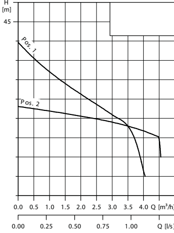
Şekil 3 QH eğrisi ve ejektör valfi konumları
