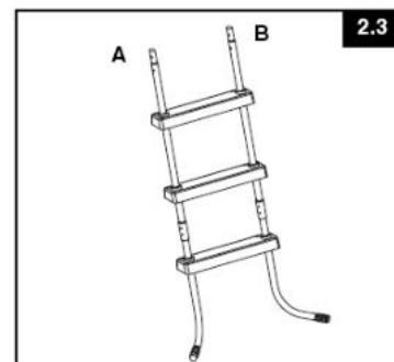
**Obrázek 2.2:** Zatlačte upevňovací kolík pro příčky do otvorů, abyste příčku upevnili v montážním mechanismu.
