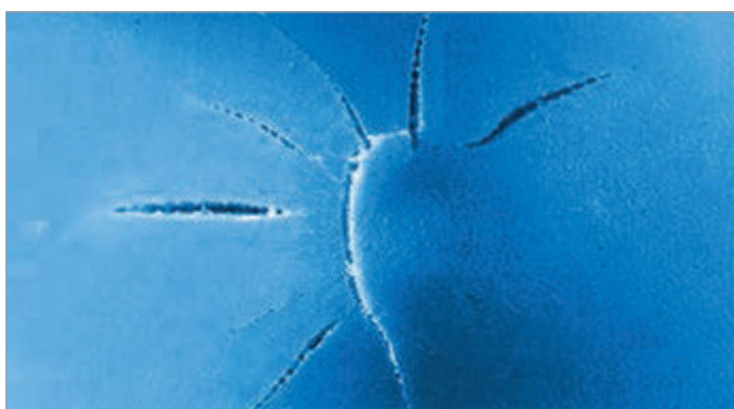
Poškození dlouhodobým působením napětí
