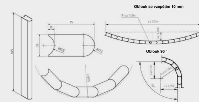
Možné jsou i oblouky. Zde máte k dispozici obloukovou formu SILCAHEAT® 600C R75. Přesné přířezy v patřičné tloušťce desky 625 mm ulehčí vytváření požadované formy i při různém poloměru jak vypuklý (konvexní), tak i vyhloubený (konkávni).
