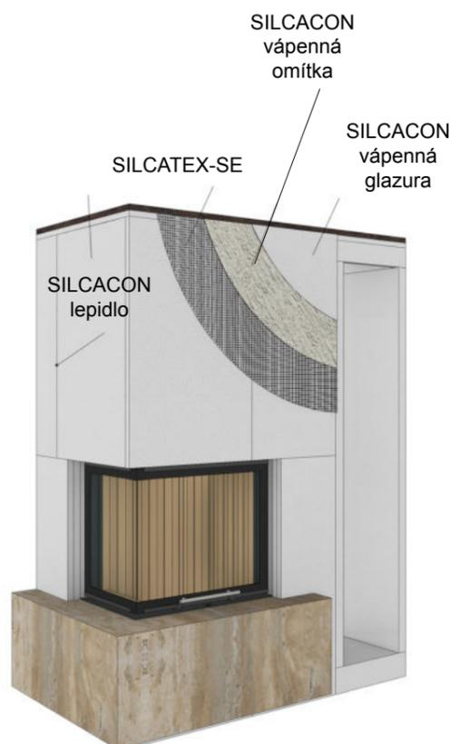
SILCACON základový nátěr se zde kvůli vysokým teplotám nepoužívá. Doporučuje se úprava desky impregnací SILCA-DUR HTI. Omítka se vyztužuje sklovláknitou mřížkovou tkaninou odolnou vůči vysokým teplotám SILCATEX-SE.
