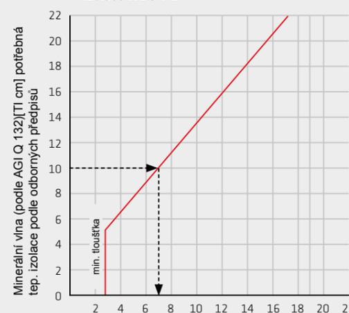
Příklad: Potřebná tepelná izolace (TI) s minerální vlnou (podle AGI Q 132) podle údajů výrobce: 10 cm
