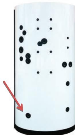
10. Usadit plech proti čtyřem trnům a přichytit pomocí 4 šroubů M6x16 s podložkou (kódy 12996 a 7853 – součást sady 12226). Při montáži také umístit za plech podložky a povolit objímky. Namontovat čerpadlovou skupinu se čtyřcestnými směšovacími ventily (kód 12224 nebo 12225). Pomocí převlečné matice 5/4" spojit s dříve namontovanou skupinou (viz bod 5) s rohovým kohoutem. Utáhnout objímky.
