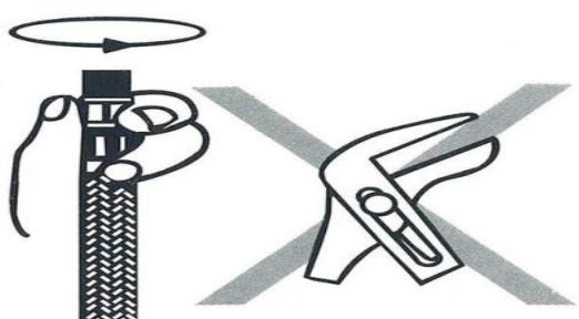
**Toto napojení dotáhněte rukou nebo vhodným klíčem maximální silou ne větší než 10 Nm.**
