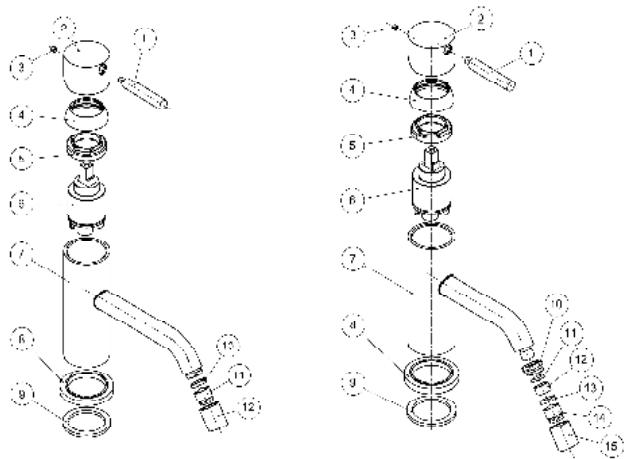
pravou hadičku na studenou vodu. Pomocí svěracího šroubu připojte ovládací část pro automatickou výpust na odpad. Zkontrolujte těsnost všech spojení.
