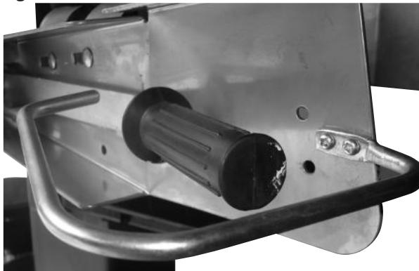
**Sicherungsbügel an Bedienarme montieren, Fig. 4.1**
