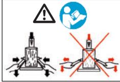
Prima della messa in funzione dell'apparecchiatura, prende familiarità con il funzionamento della leva a due mani!
