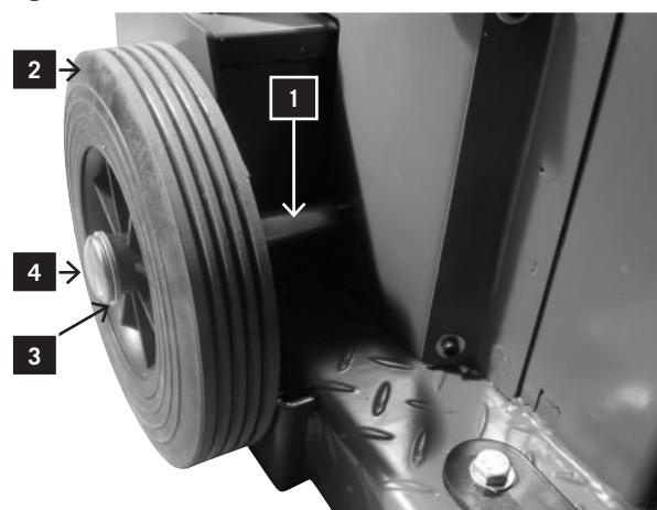
**Laufräder montieren, Fig. 5**
