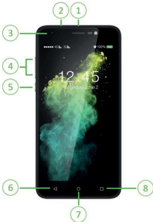
**Konektor pro nabíjení** (č. 1 v obrázku) slouží pro připojení nabíjecího kabelu USB. Připojením vašeho telefonu k počítači můžete využít dalších dostupných funkcí (více v sekci Připojení k počítači).
