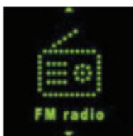
V hlavním rozhraní zvolte menu **Radio** (rádio) krátkým stisknutím tlačítka ◀/▶, pak otevřete rozhraní rádia krátkým stisknutím tlačítka **MENU**.
