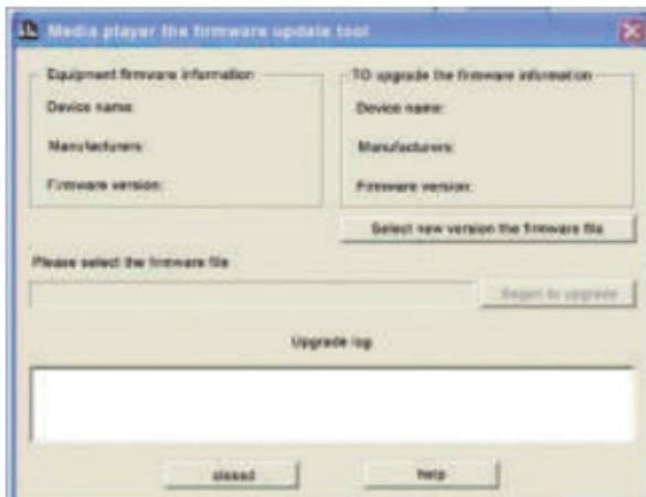
C. Soubor firmwaru stáhněte z počítače kliknutím na „select new version the firmware file“ (zvolit soubor nové verze firmwaru). Spusťte aktualizaci softwaru kliknutím na tlačítka „start“.
