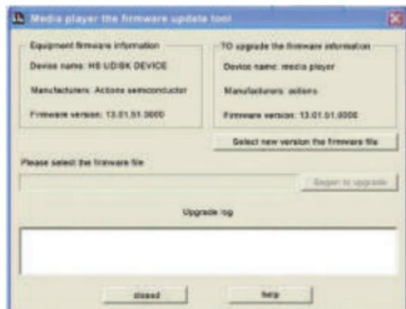
D. Během aktualizace firmwaru nepřerušujte spojení přehrávače s PC. Po dokončení aktualizace software zobrazí zprávu „the firmware update successful, program will automatically exit!“ (Aktualizace firmwaru úspěšná, program bude automaticky ukončen!). Potom by se měl přehrávač automaticky vypnout a restartovat, aktualizace je tak dokončena.
