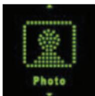
V hlavním rozhraní zvolte menu **Photo** (fotografie) krátkým stisknutím **◀/▶**, pak otevřete seznam obrázků krátkým stisknutím **MENU**. Zvolte obrazový soubor stisknutím **◀/▶**, obrázek zobrazte stisknutím **▶II**, zobrazení opět zavřete stisknutím **▶II**.
