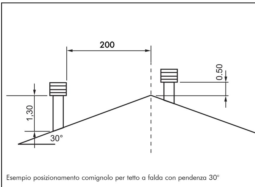
Esempio posizionamento comignolo per tetto a falda con pendenza 30°
