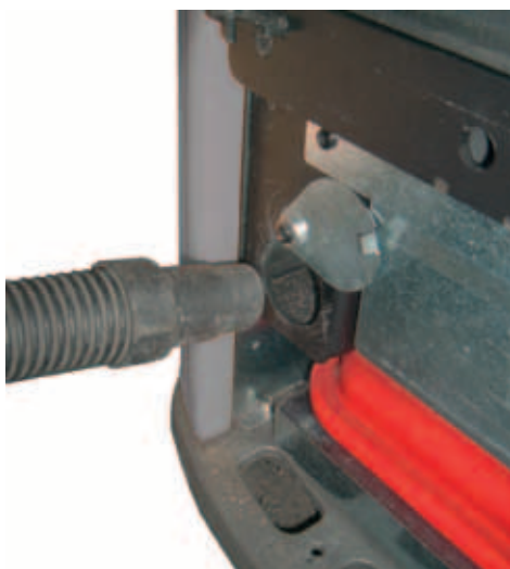
Die Rauchabzüge mit einem geeigneten Staubsauger oder unseren Aschessauger EDILKAMIN saugen
