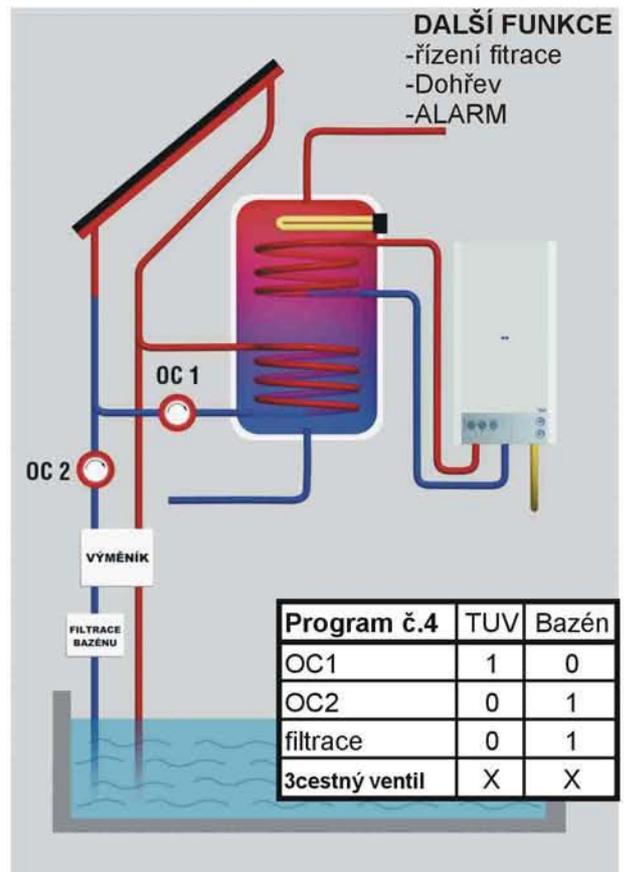
Program č.4 použijeme v případě kdy, místo oběhového čerpadla využíváme motor od filtrace.
