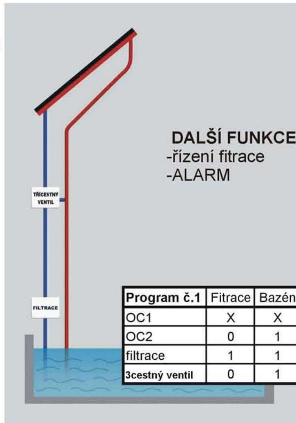
Program č.1 se používá pokud solární panely slouží k ohřevu bazénu. Jestliže je k oběhu vody využito čerpadlo od filtrace, může tato řídicí jednotka ovládat i fitraci bazénu. V případě použití jiného motoru než od filtrace, využijeme výstup pro Oc2. Výstupy jsou spínány podle pravdivostní tabulky č.1
