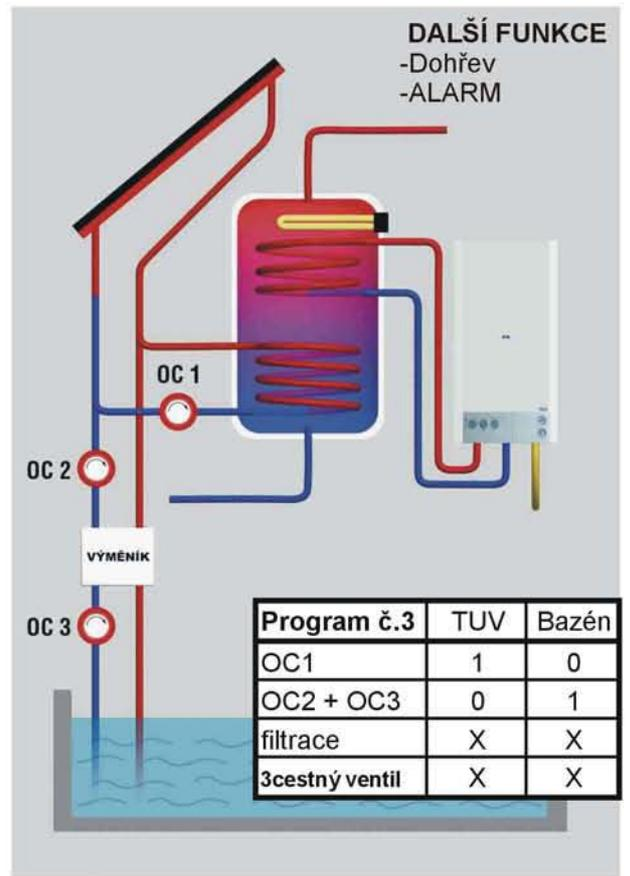
Program č.3 se používá při využití solárních panelů k ohřevu TUV a bazénu v systému s třemi oběhovými čerpadly.
