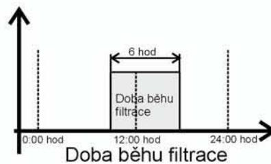
**Okamžik zapnutí filtrace** - časový střed délky běhu filtrace je určen na 14:00 hod. **Př:** pokud má být filtrace zapnuta na dobu 6 hod. Bude automaticky zapnuta v 11:00 hod a vypnuta v 17:00 hod.
