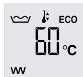
We wskazaniu przy ograniczeniu menu wyświetlane są symbole nagzewania, zwapnienia oraz Serwis/Błąd, jak opisano w rozdziale „Ustawienia / Elementy obsługi i wyświetlacz standardowy”.
