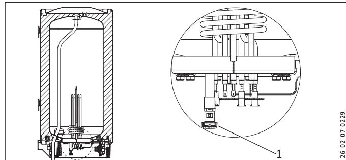
1 Kołpak zaworu spustowego
