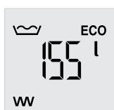
На дисплее показано доступное количество смешанной воды с температурой 40 °C при температуре холодной воды 15 °C.
