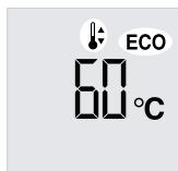
Para ajustar el límite de menú, mantenga el botón pulsado durante más de 3 segundos hasta que parpadee la pantalla de temperatura de referencia. Aparece el ícono de temperatura de referencia. Aparece el ícono del modo ECO (parpadea en los modos ECO Plus y ECO Dynamic).
