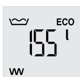
Zobrazí se aktuálně dostupné množství smíšené vody s teplotou 40 °C při teplotě studené vody 15 °C.
