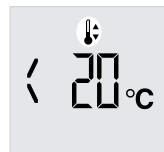
Si ajusta la temperatura de referencia con el botón "-" a menos de 20 °C, solo estará en funcionamiento la protección antiescarcha.
