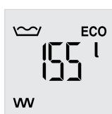
Se muestra el contenido de agua de mezcla de 40 °C disponible actualmente con una temperatura de agua fría de 15 °C.
