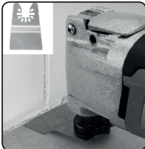
Obr.2, odstraňování zbytků lepidla či tmelů škrabkou
