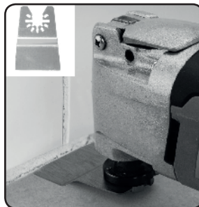
2. ábra. Ragasztó- és tömítőanyag maradványok eltávolítása kaparóval.
